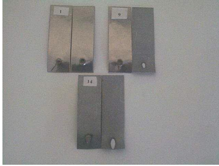
Şekil 47: Çekme Deneyi Sonrası Kopan Kaynaklı Numuneler
