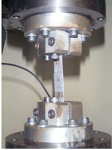
Şekil 4.14 : Çeneler Arasına Tutturulmuş Kaynaklı Yorulma Deney Numunesi
