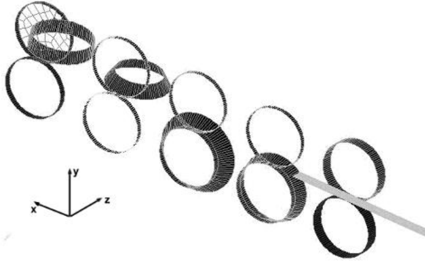
Şekil 5.2. Simülasyonda kullanılan makara setleri yerleşimi. (XY düzleminde simetrik olduğu için yarısı modellenmiştir. Sac kalınlığı (T) 0,6 mm alınmıştır.)
