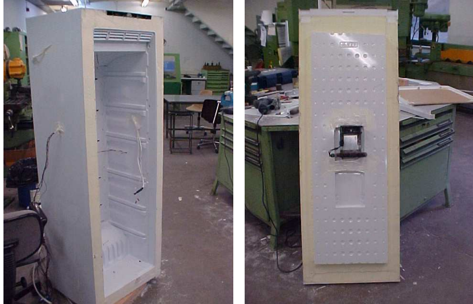
Şekil 4.4 : Kesilmiş Durumda Ters Isı Kazancı Deneyi Yapılan Derin Dondurucu
