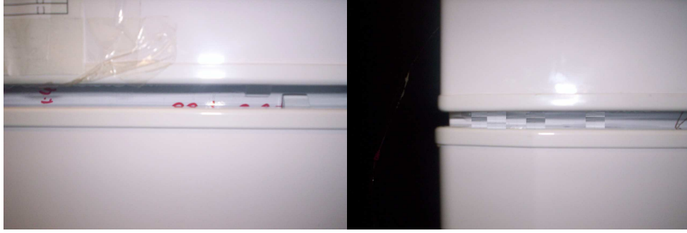
Şekil 4.17 : Terleme Deneyi Sonucunda Buzdolaplarının Görünümü
