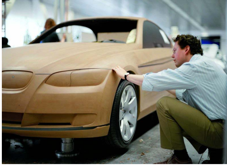
Şekil 2.9 : 1:1 ölçekli kil modeller, otomobil tasarım sürecinde önemli bir aşamadır.
