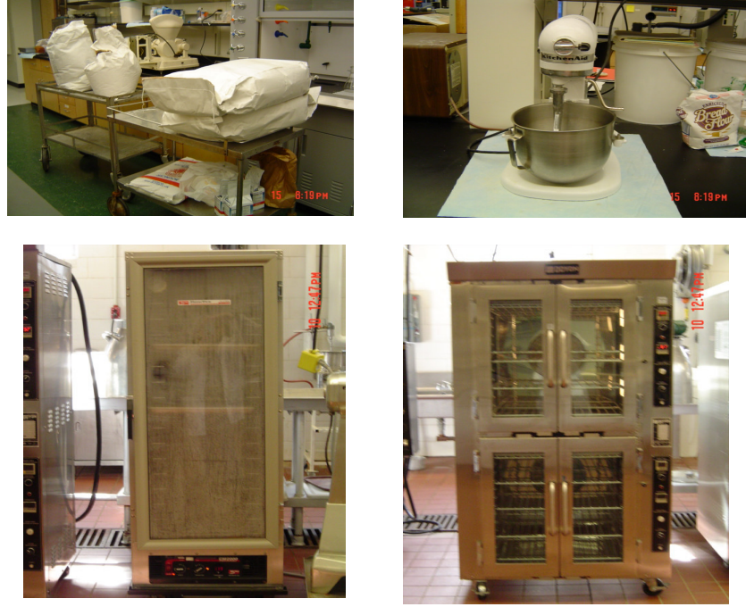
Şekil 3.3: Ekmek üretiminde kullanılan bileşenler, hamur karıştırma mikseri, fermentasyon kabini ve pişirme fırını.
