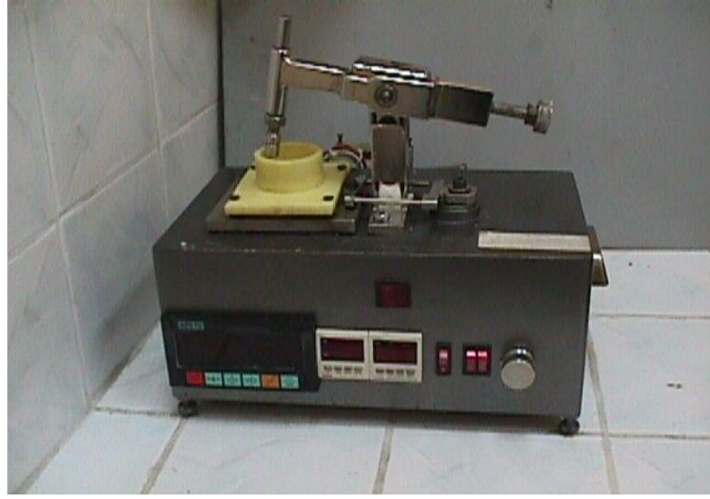
Şekil 4.2 Aşınma testlerinin yapıldığı ileri - geri (reciprocating) aşınma deney cihazı
