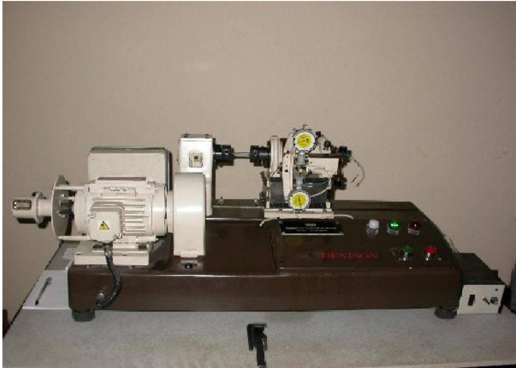
Şekil 4.2 Denison 7615 Marka Yorulma Cihazı
