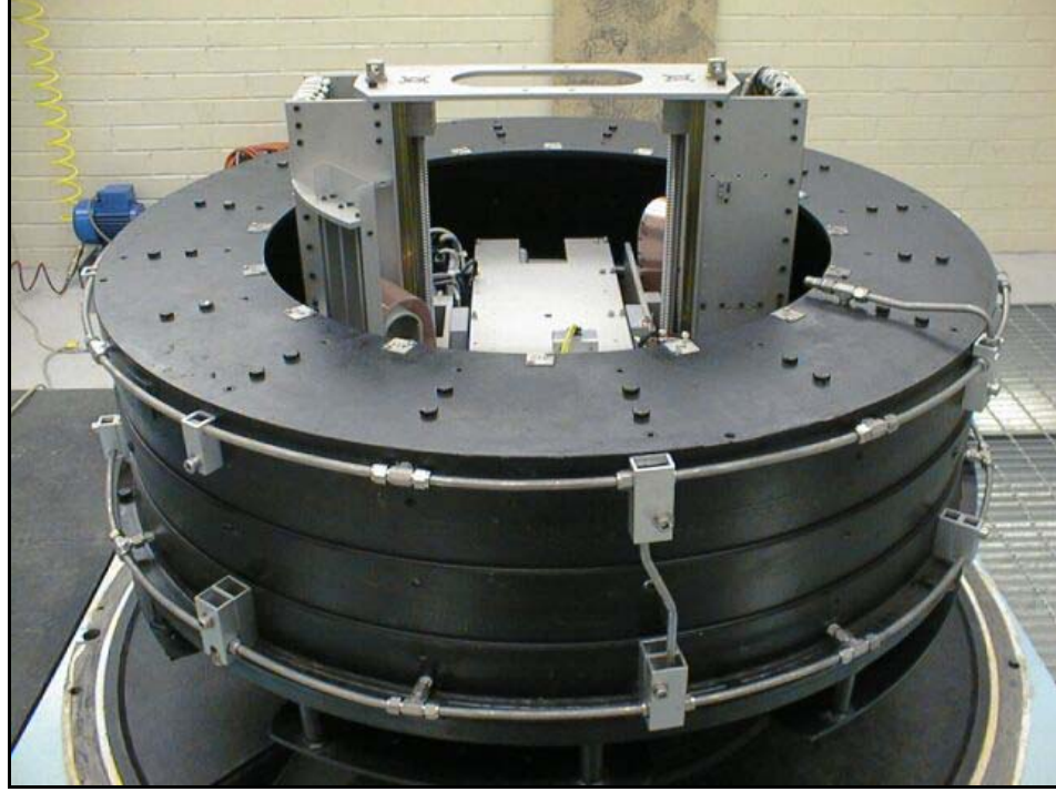
Şekil 3.5: Batı Avusturalya Üniversitesi'nde kullanılan davul santrifüj, koruyucu kapak yok
