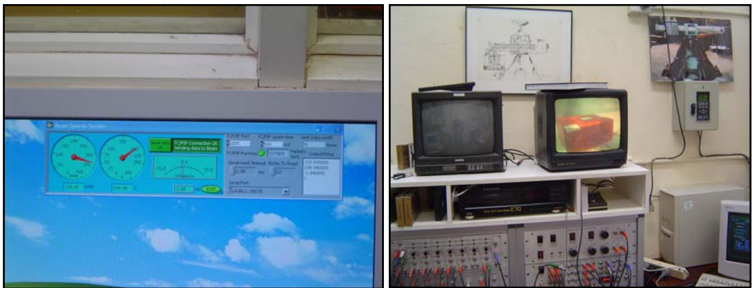
Şekil E.6: Santrifüj kontrol odasında deney sırasındaki santrifüj kontrolleri ve kamera kayıtları
