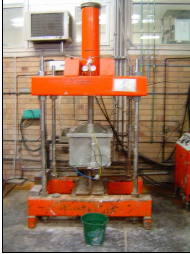
Şekil E.1: Numunenin laboratuvar şartlarında (1g) preste konsolidasyonu
