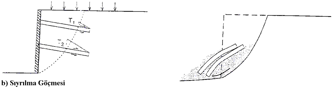
Duvarın çivilerin pasif bölgeden sıyırılması sonucu göçmesi
