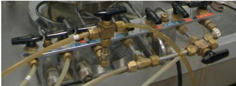
Şekil 3.2 Hücre alt tablasına bağlı vanaların gösterimi
