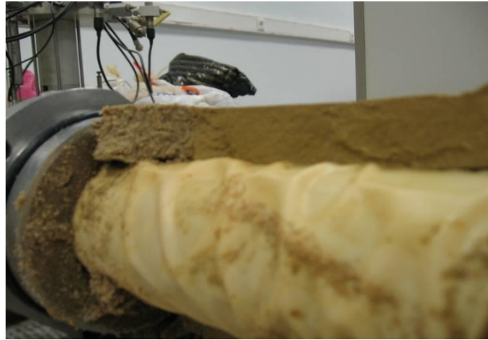
Şekil B7 Tek silt tabakalı kumlu zemine ait fotoğraflar (Deney No:12 Silt tabakası kalınlığı 12 cm)
