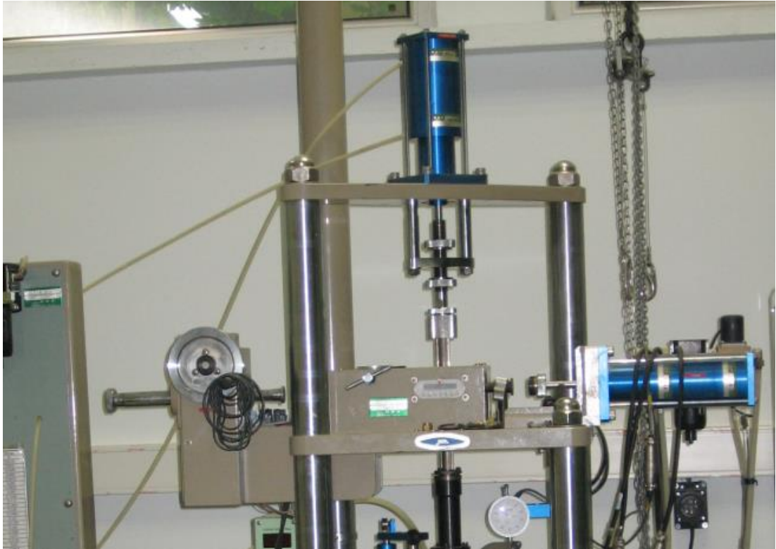
Şekil 3.4 Düşey yük sistemi ve burulma momentinin genel görünümü
