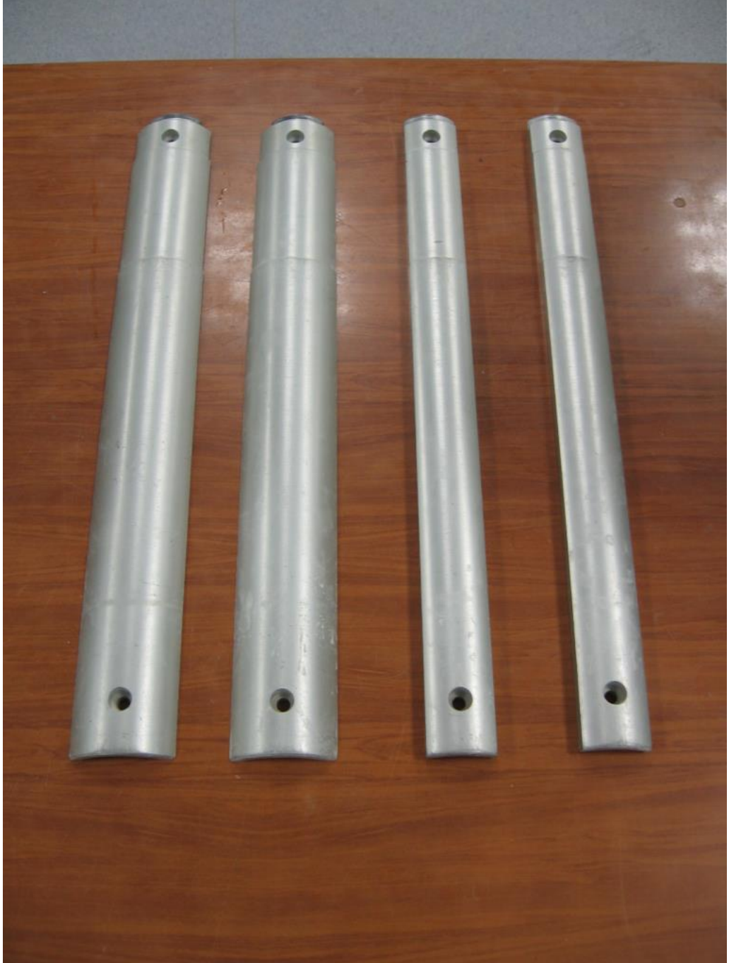
Şekil 3.9 Numune hazırlama aşamasında kullanılan iç kalıplar
