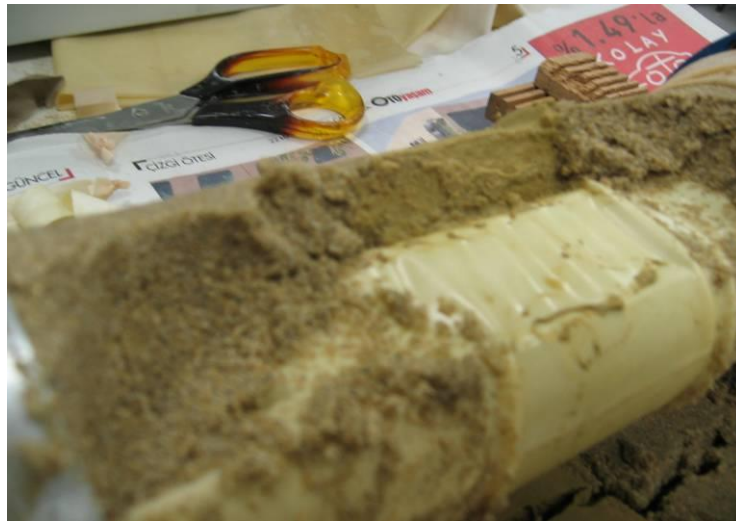
Şekil B1 Tek silt tabakalı kumlu zemine ait fotoğraflar (Deney No:13 Silt tabakası kalınlığı 6cm )
