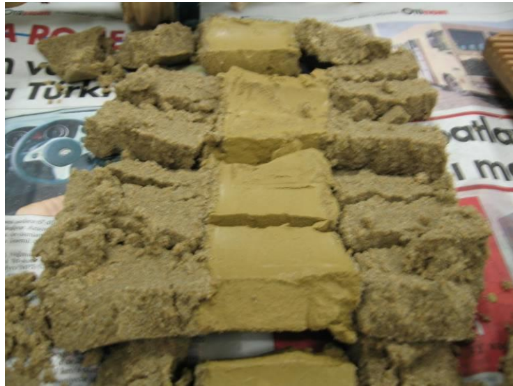
Şekil B3 Tek silt tabakalı kumlu zemine ait fotoğraflar (Deney No:14 Silt tabakası kalınlığı 6cm)
