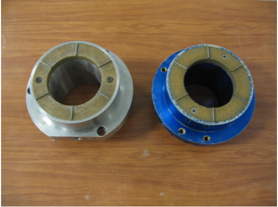
Şekil 3.10 Numune hazırlama aşamasında kullanılan alt ve üst başlıklar
