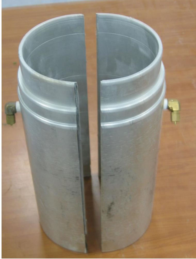
Şekil 3.11 Numune hazırlama aşamasında kullanılan dış kalıplar
