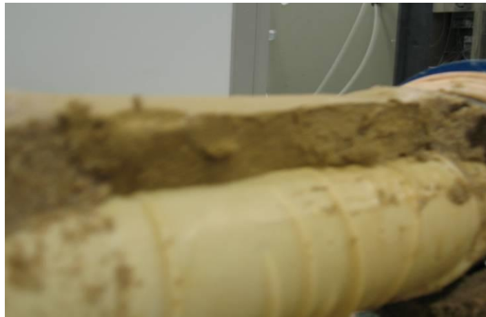
Şekil B5 Tek silt tabakalı kumlu zemine ait fotoğraflar (Deney No:11 Silt tabakası kalınlığı 12 cm)
