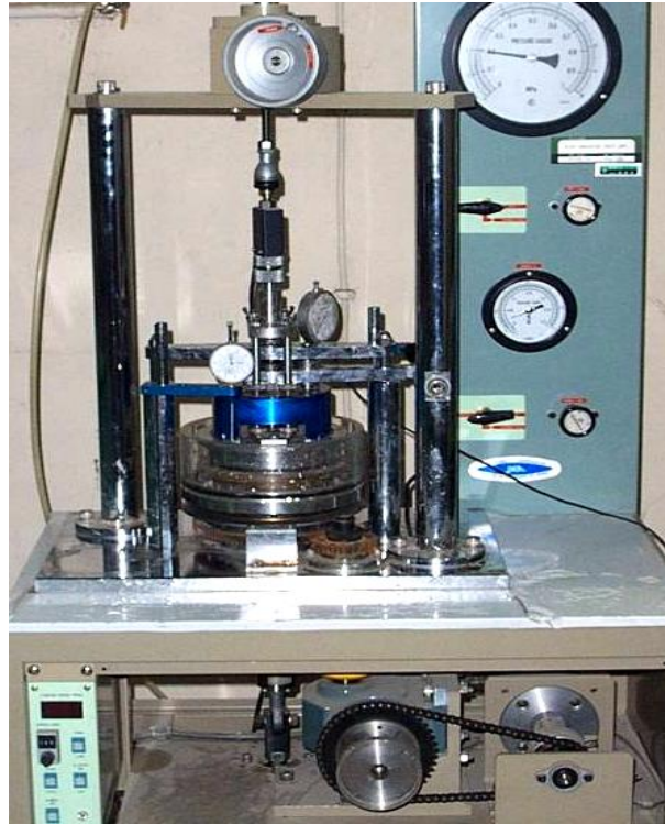
Şekil 3.1 İ.T.Ü. halka kesme deney aleti
