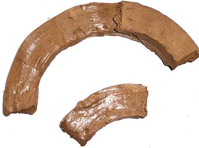
Şekil 3.29 Deney sonrası kesilmiş numunenin görünümü
