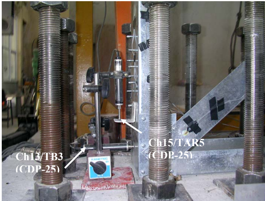
Şekil 5.11 Yer Değiştirme Ölçerlerin Gösterimi
