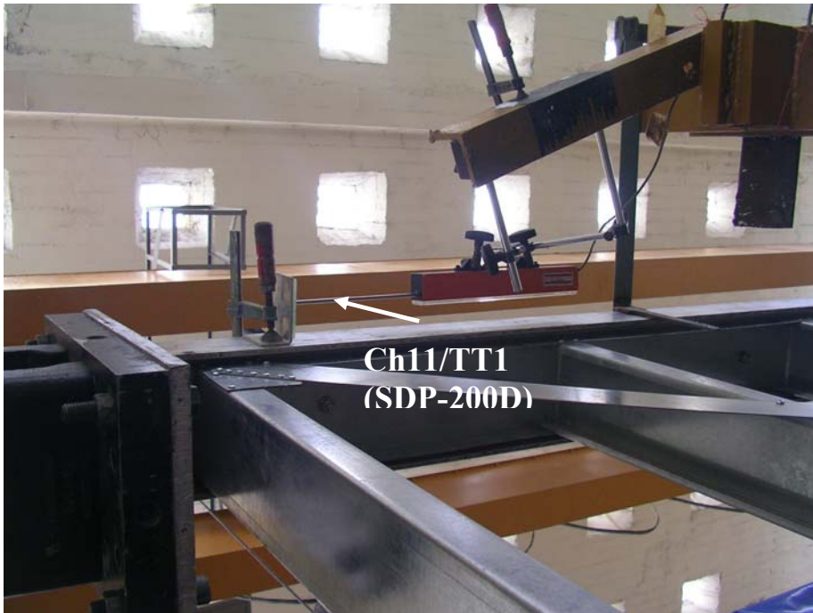
Şekil 5.9 Yer Değiştirme Ölçerin Gösterimi
