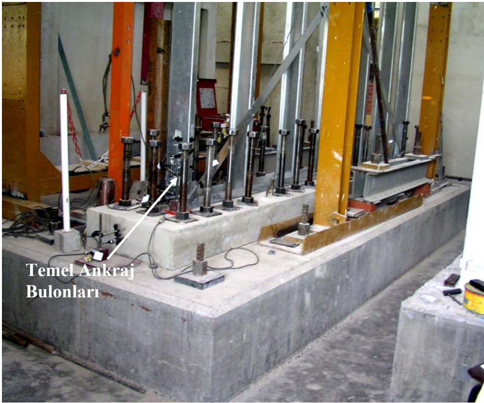
Şekil 5.5 Deney Temel Sistemi
