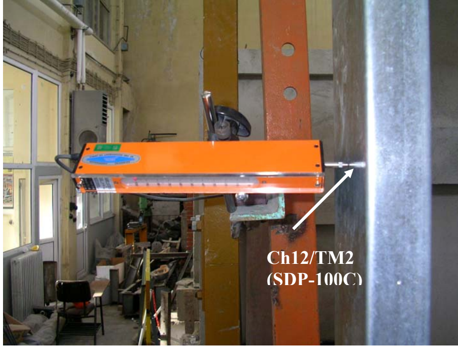
Şekil 5.10 Yer Değiştirme Ölçerin Gösterimi
