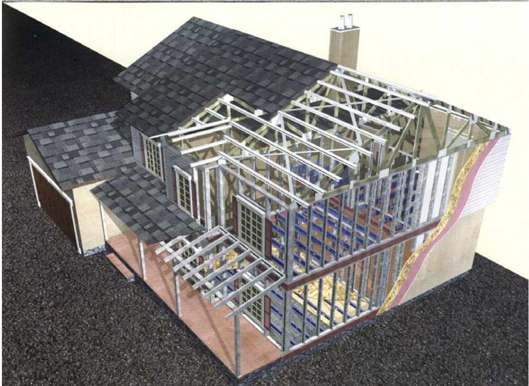
Şekil 4.1 Hafif Çelik Yapı İskelet Sistemi [7]
