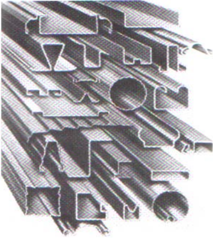
Şekil 1.1 Soğukta Şekillendirilmiş Kesitlerin Çeşitli Şekilleri [4]
