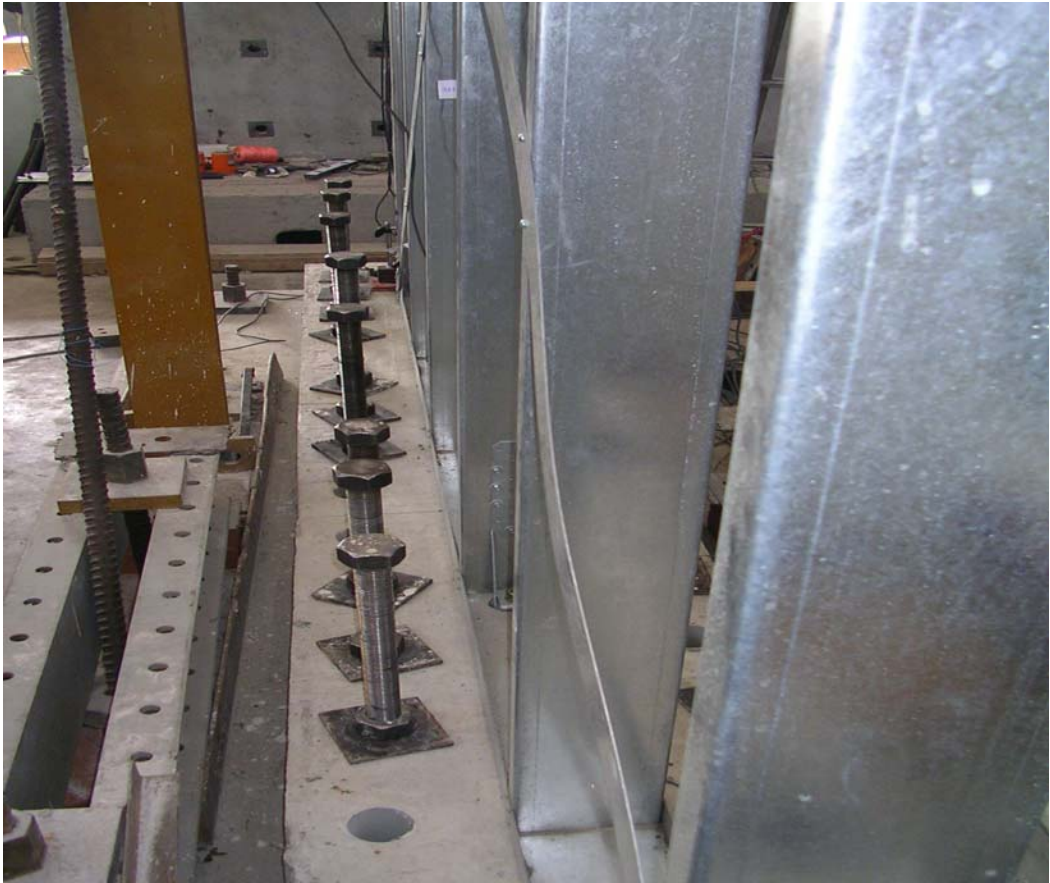
Şekil A.2 Basınca Çalışan Çapraz Elemanı Burkulması
