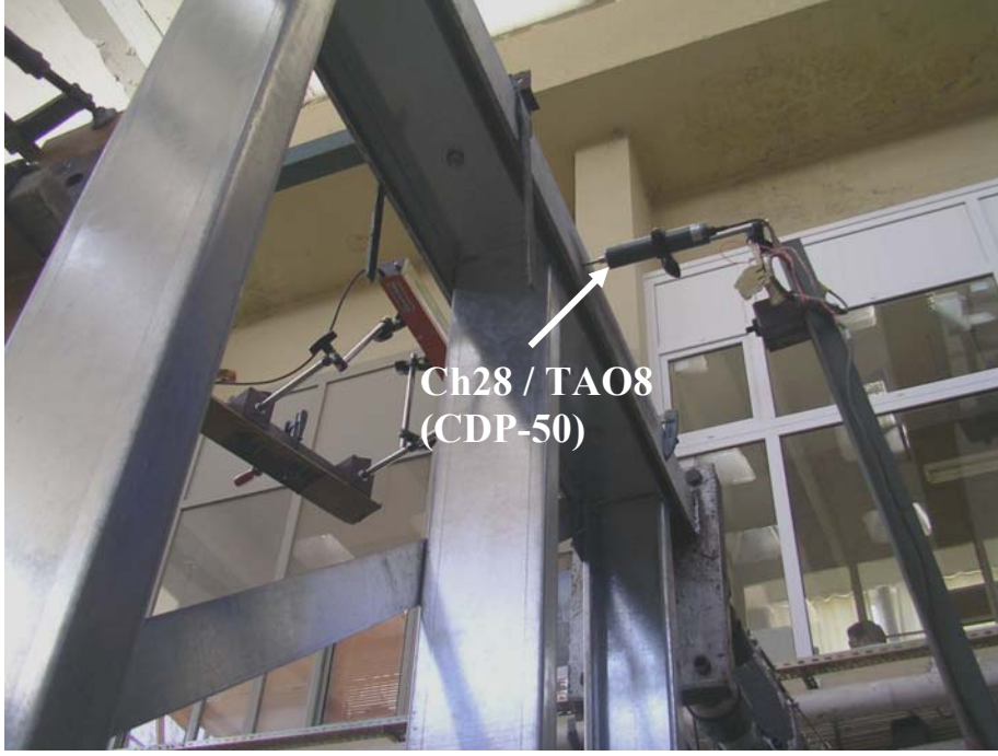
Şekil 5.8 Yer Değiştirme Ölçerin Gösterimi
