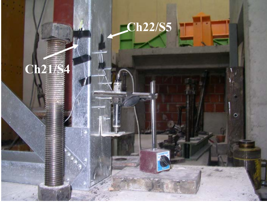
Şekil 5.14 S4 ve S5 İsimli Şekil Değiştirme Ölçerlerin Yerlerinin Gösterimi
