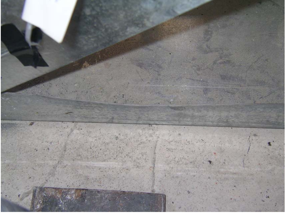
Şekil A.3 Alt Başlık U Profilinin Yerel Burkulması
