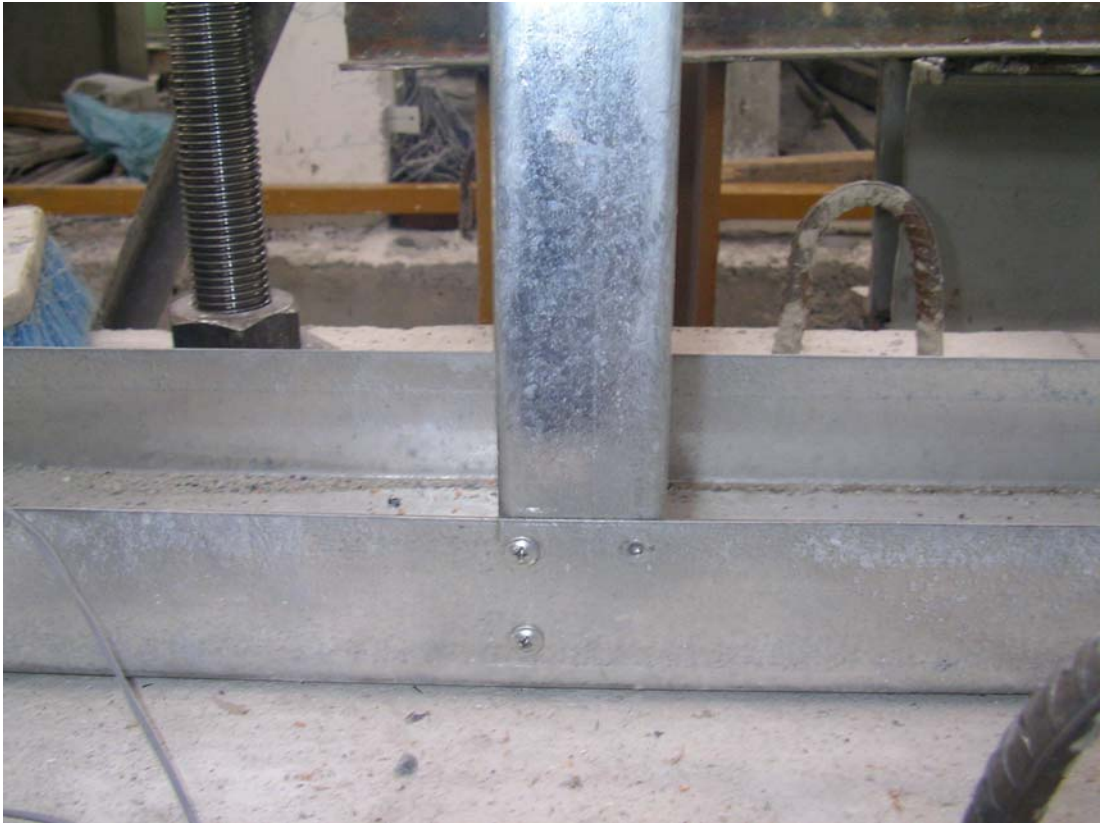
Şekil A.6 Alt Başlık ve 6. Dikme Birleşimindeki Vida Başının Kopması
