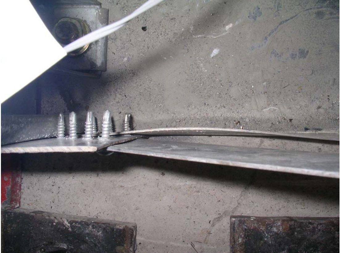
Şekil A.4 Alt Başlık U Profilinde Meydana Gelen Yerel Burkulma
