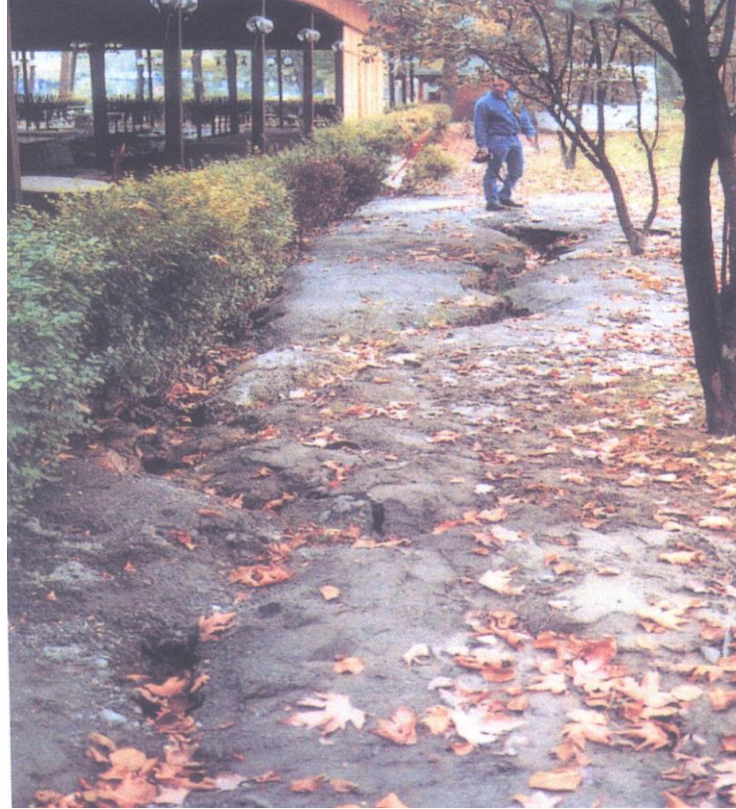
řekil 3.15. Sapanca Gölü'nün doęu sahilinde yüzey çatlakları ve kum fiřkırmaları
