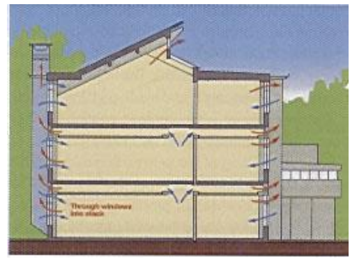
Şekil 3.56. BRE B n ası Haval andır m a S i s t e m i
