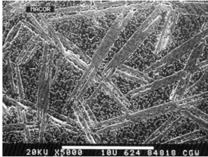
Şekil 4.1: Macor'a Ait Mikroyapı Görüntüsü [16].
