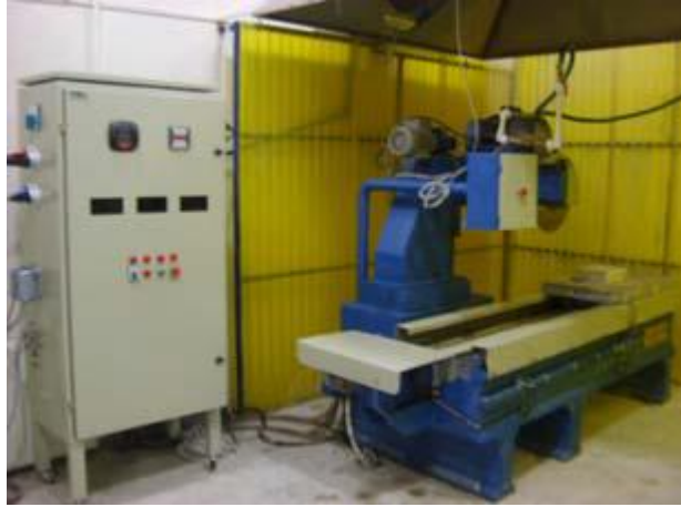
Şekil 7.10 : Bilgisayar kontrollü doğal taş kesme makinesi [38].
