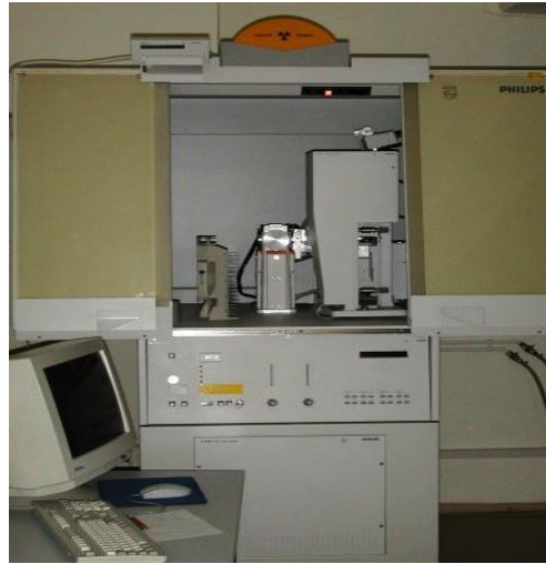
Şekil 5.2 : X ışınları difraktometre cihazı.
