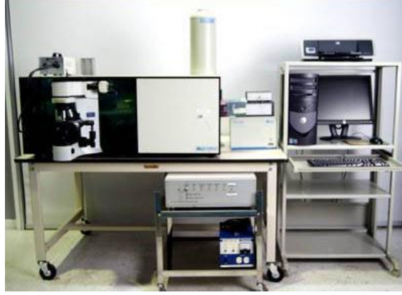
Şekil 5.3 : Raman spektrometre cihazı.
