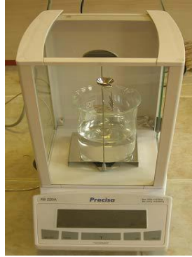
Şekil 3.9 : Preciso marka hassas terazi ve yoğunluk ölçüm aparatları.
