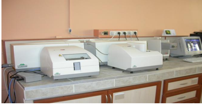
Şekil 3.2 : Mastersizer tane boyut analizi cihazı.
