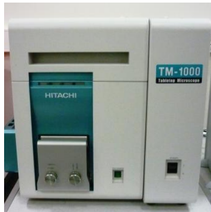
Şekil 3.10 : SEM Hitachi TM-1000 Taramalı elektron mikroskobu.
