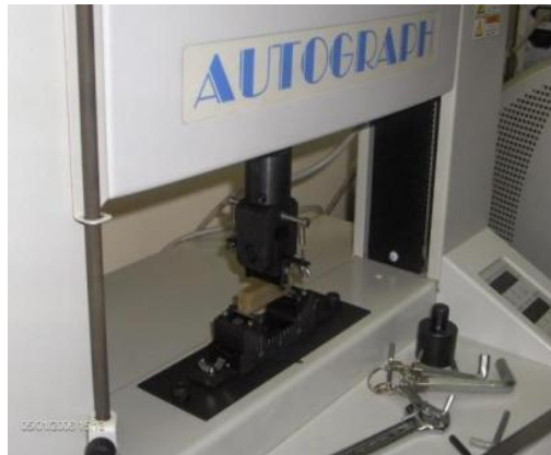
Şekil 3.7 : Autograph mekanik test cihazı.
