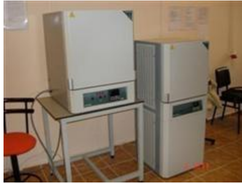
Şekil 3.6 : Protherm oksit fırınları.
