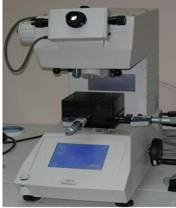
Şekil 3.8 : Shimadzu marka mikrosertlik cihazı.
