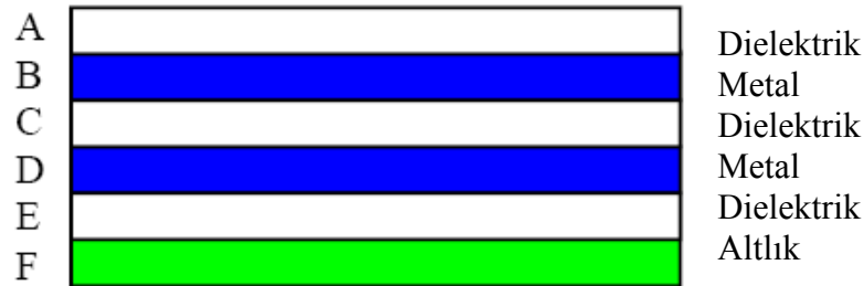
Şekil 2.3 : Çok tabakalı absorblayıcı film yapısının şematik görünümü [10]
