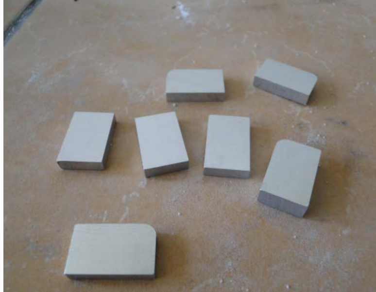
Şekil 4.1 : Kaplama işlemi için hazırlanmış Al 6082 altlıklar.
