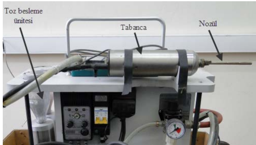
Şekil 2.3 : Portatif tip cihazın önemli parçaları.
