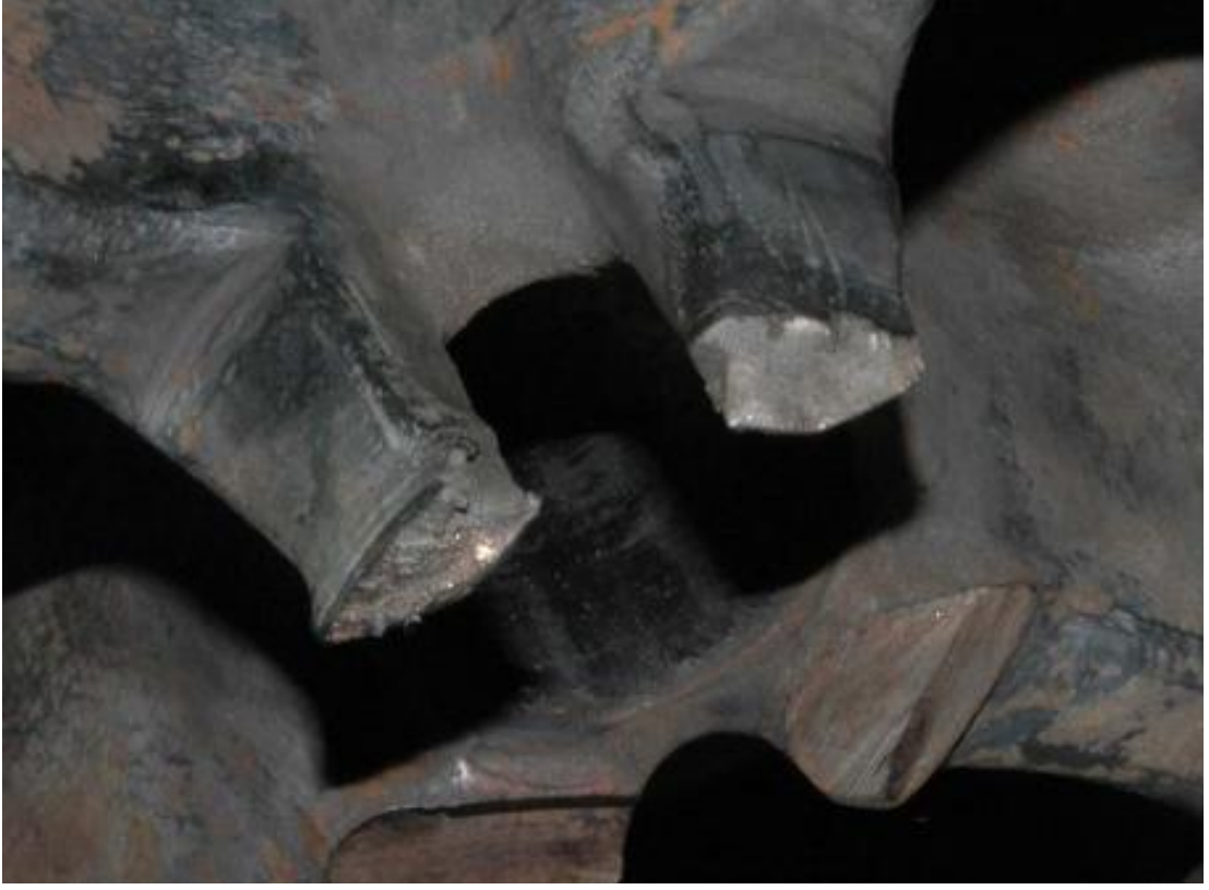
Şekil 5.2 : Kırık yüzey örneği - üst kısımda gevrek, alt kısımda sünek kırılmaya örnek [27].
