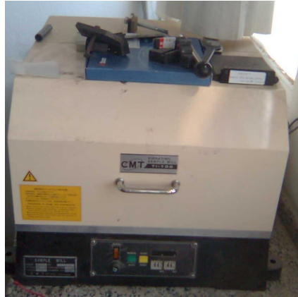
Şekil 4.2 : CMT TI-100 titreşimli değirmen öğütme cihazı
