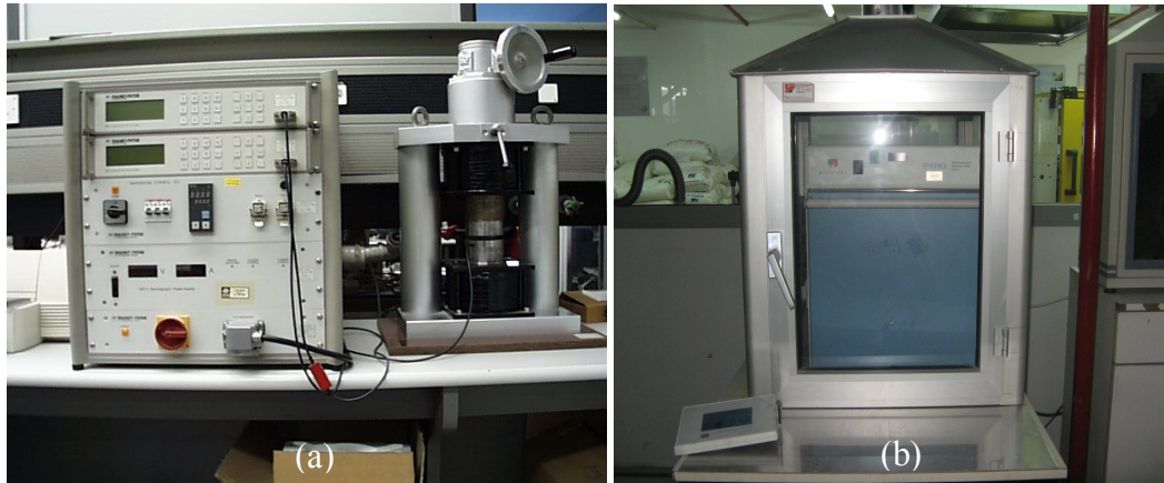
Şekil 4.13 : (a) MagnetPhysik permeagraf cihazı; (b) Milestone fırın
