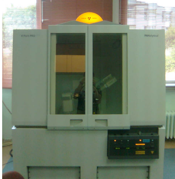
Şekil 4.7 : PANalytical PW3040/60 X'Pert Pro XRD cihazı
