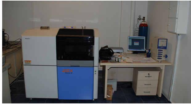
Şekil 4.5 : Rigaku ZSX Primus II XRF cihazı
