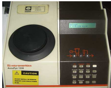
Şekil 4.11 : Micromeritics AccuPyc 1330 gaz piknometresi cihazı
