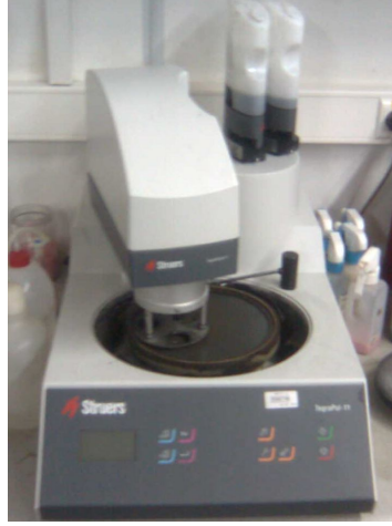
Şekil 4.1 : Struers TegraPol-11 otomatik zımpara ve parlatma cihazı
