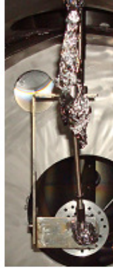
Şekil 5.4: Altlık hareketini sağlayan mafsals sistemi.
