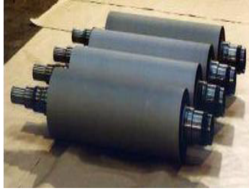
Demir-çelik endüstrisinde sürekli tavlama proses hattında kullanılan silindirlerin kaplaması
