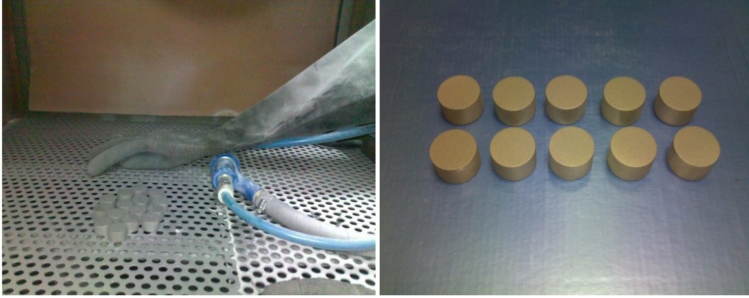
Şekil 8.3 : Elle kumlama cihazı kabin içi ve ASTM F67-89 titanyum ingotların kumlama sonrası görüntüsü.
