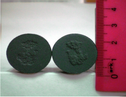
7. grup-690 kg'da kopan numunenin kopma yüzeyi (Koheziv)
