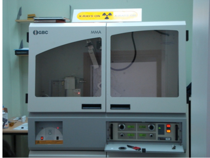
Şekil 5.9: X-ışınları difraksiyon ölçümü için kullanılan GBC™ MMA027 XRD cihazı.
