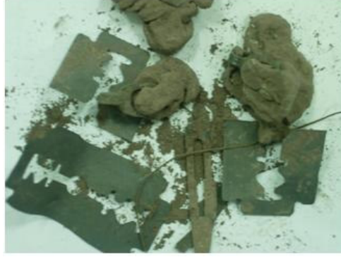
Şekil 5.26: Manyetik ayırma ve gözle kontrol sonucu elde edilen parçalar
