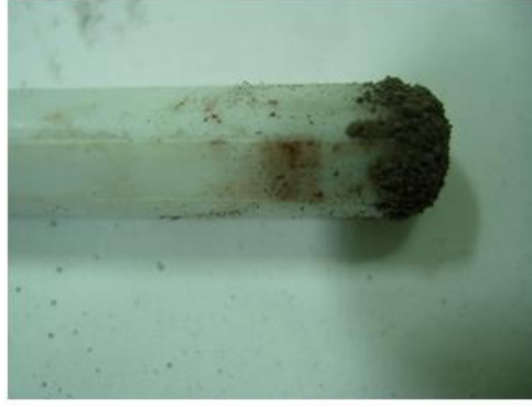
Şekil 5.27: Manyetik ayırma sonucu mıknatıs görüntüsü
