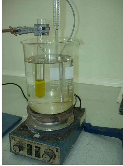
Şekil 4.2: Laboratuar ölçekli liç sistemi
