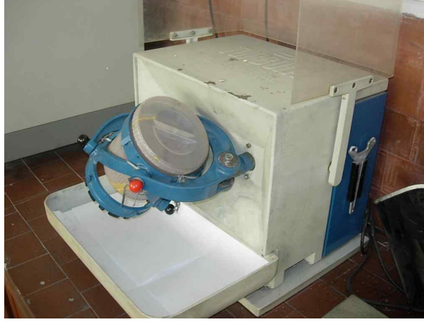
Şekil 4.6: 3 eksenli hareket edebilen toz karıştırma cihazı
