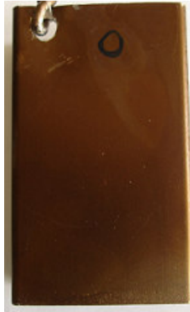
Şekil 7.12: 120 saat tuz püskürtme testi sonunda korozyona uğramış numune
