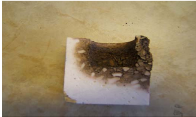
Şekil 4.9: q=0,24'e göre hazırlanan refrakterin curufuyla korozyona uğramış ara yüzeyi Ayrıca curufun yayılım alanı bu numunede 717 mm 2 bulunmuştur. Bu refrakter e ait Şekil 4.10'da sunulan sonuçlar SEM/EDS analizleri ile elde edilmiştir.
