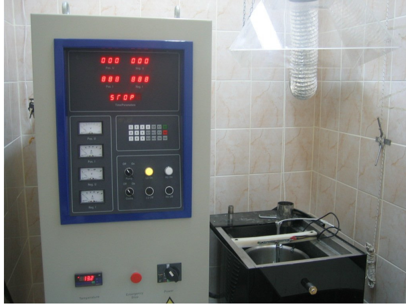
Şekil 4.1: Deneylerde Kullanılan Mikro Ark Oksidasyon Cihazı.
