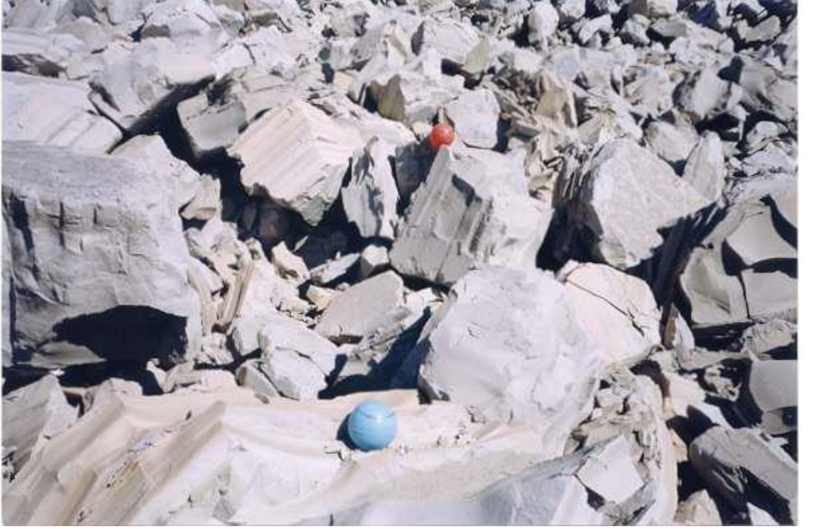
Ek-A.3 Deneme 3 Çalışması Patlatma Sonrası Görünüşü
