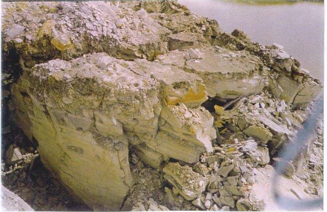
Fotoğraf 4.15 Patlatma Sonrası Ayrılmamış Basamak Üst Kısımının Yandan Görünüşü
