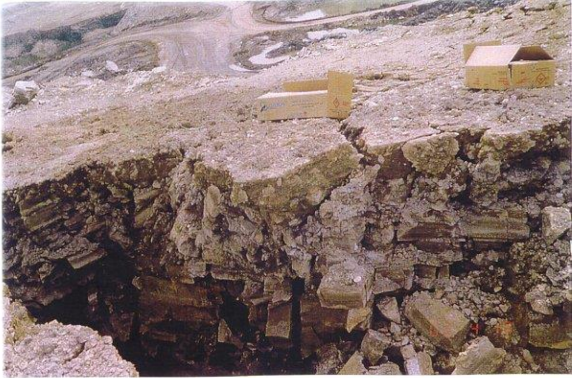
Fotoğraf 4.14 Patlatma Sonrası Tam Ayrılmamış Basamak Üst Kısmının Görünüşü
