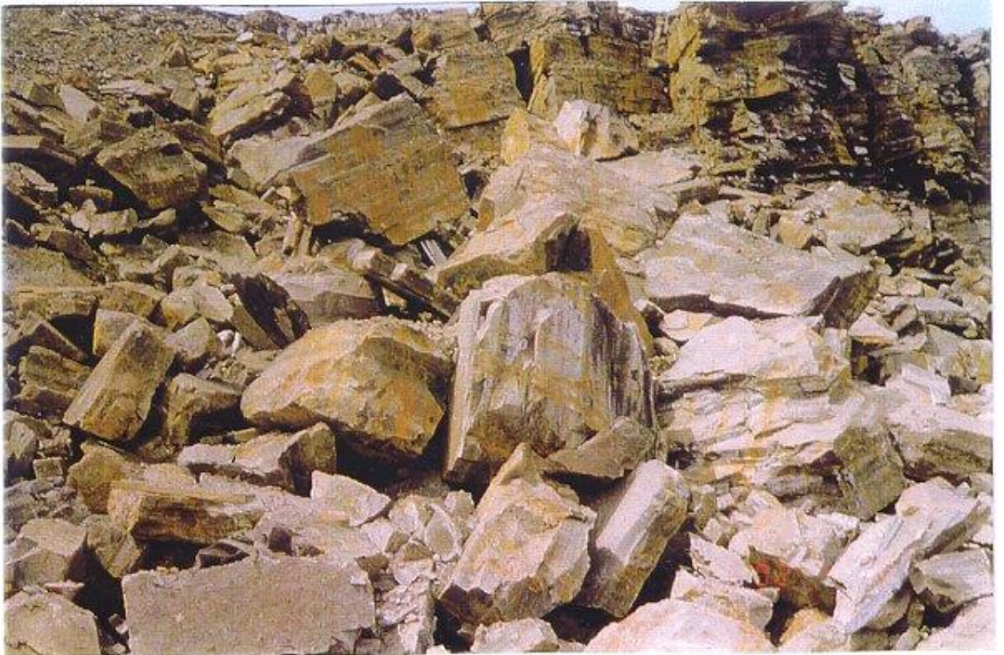
Fotoğraf 4.16 Patlatma Sonrası İri Parça Boyutunun Görünüşü
