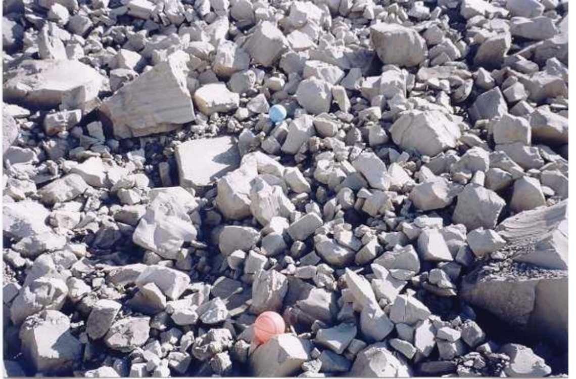
Ek-A.9 Deneme 6 Çalışması Patlatma Sonrası Görünüşü
