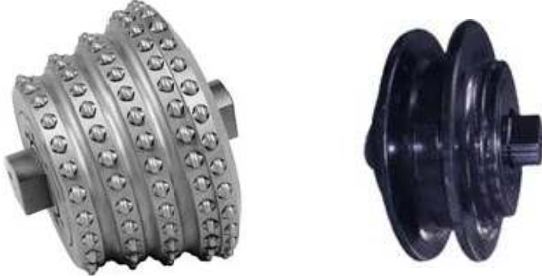
Şekil 2.21: (A)Çok sıralı tungsten karbür butonlu keski,(B)Çok sıralı disk keski [36].
