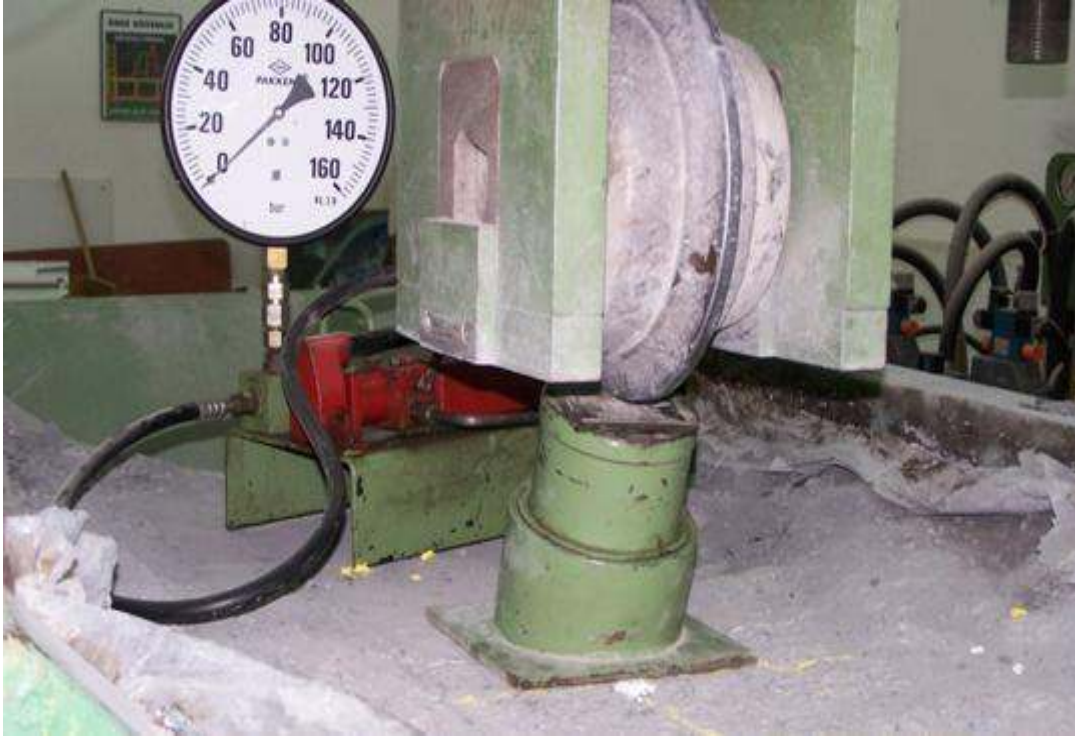
Şekil 3.21: Hidrolik piston ile yapılan kalibrasyon çalışmaları (13 inç CCS tip disk, 15 derece eğim ile yükleme).
