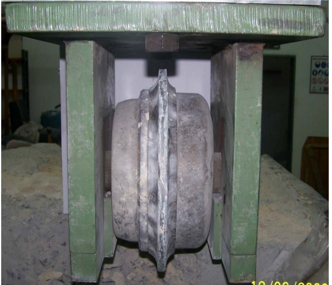
Şekil 3.31: 13 inç CCS tip disk keski.
