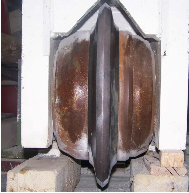
Şekil 3.32: 15 inç V tip disk keski.
