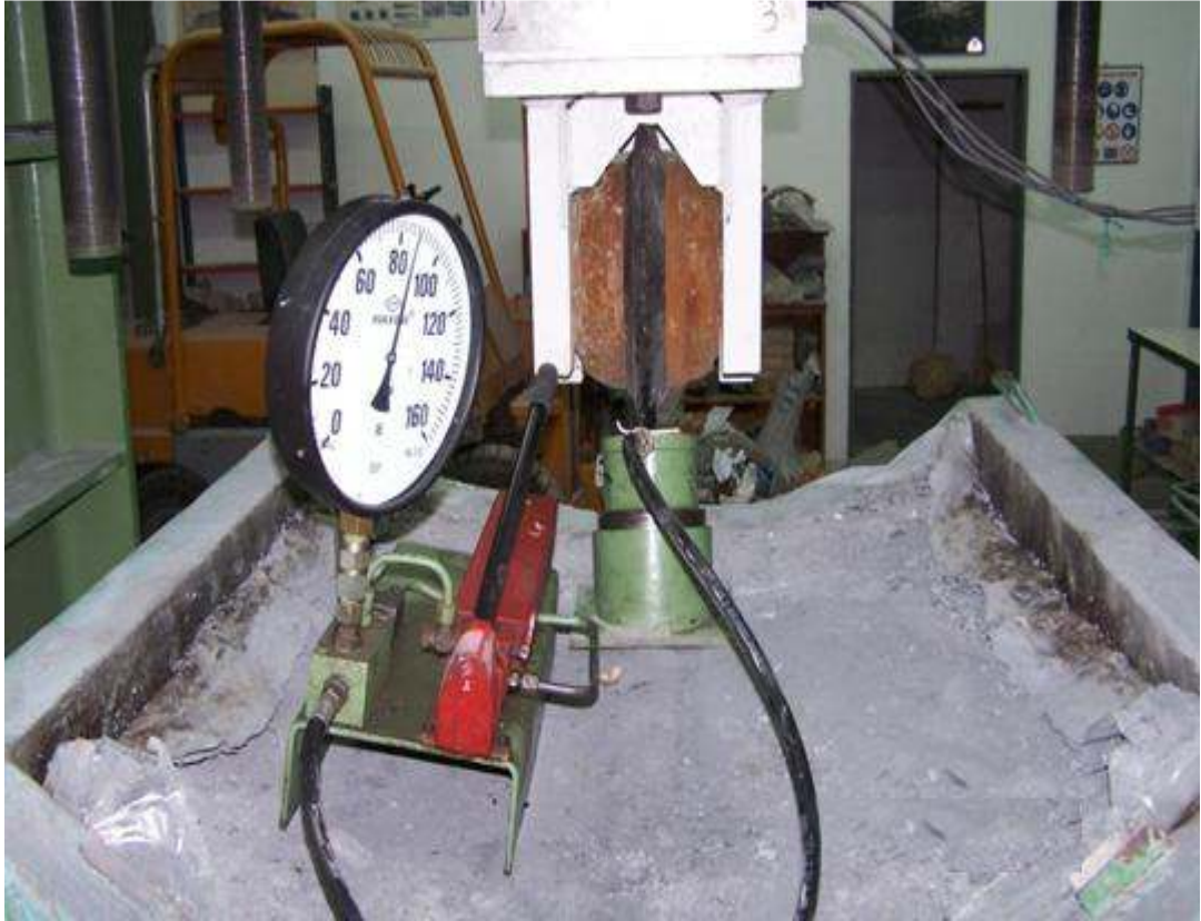
Şekil 3.24: Hidrolik piston ile yapılan kalibrasyon çalışmaları (15 inç V tip disk, 15 derece eğim ile yükleme).
