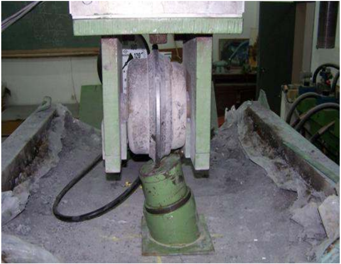
Şekil 3.22: 13 inç CCS tip disk keski için 15 derece eğimde yanal yükleme ile kalibrasyon.
