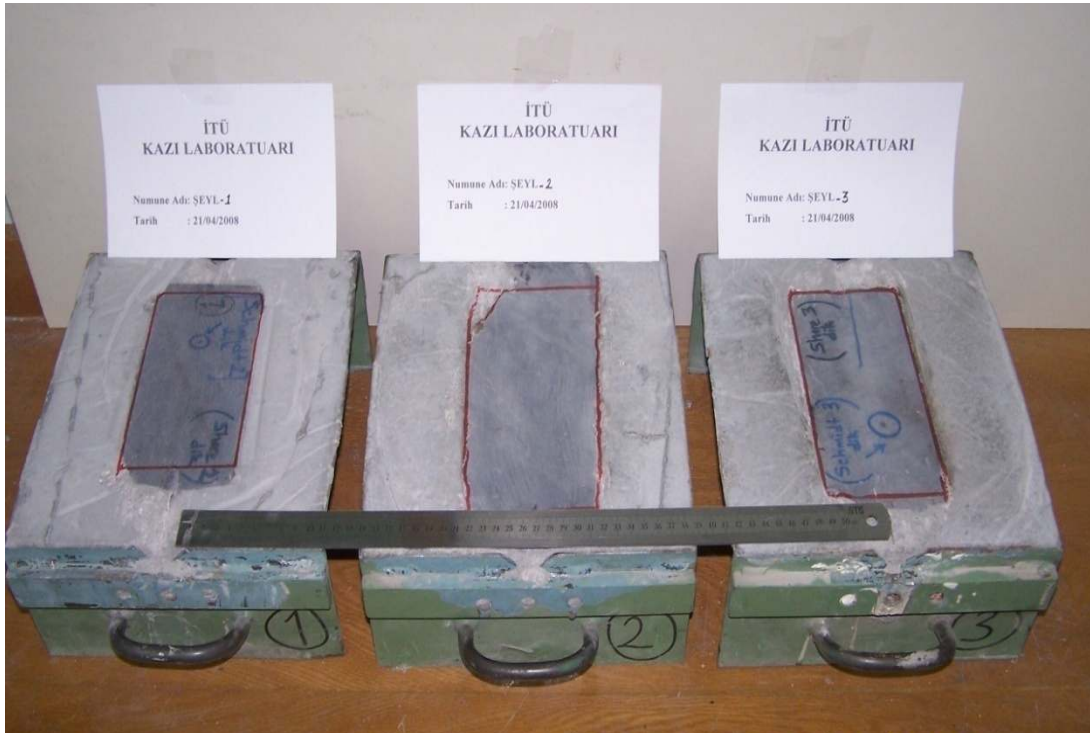
Şekil 3.42: Taşınabilir doğrusal kazı seti (PLCM) için hazırlanmış örnek numune.
