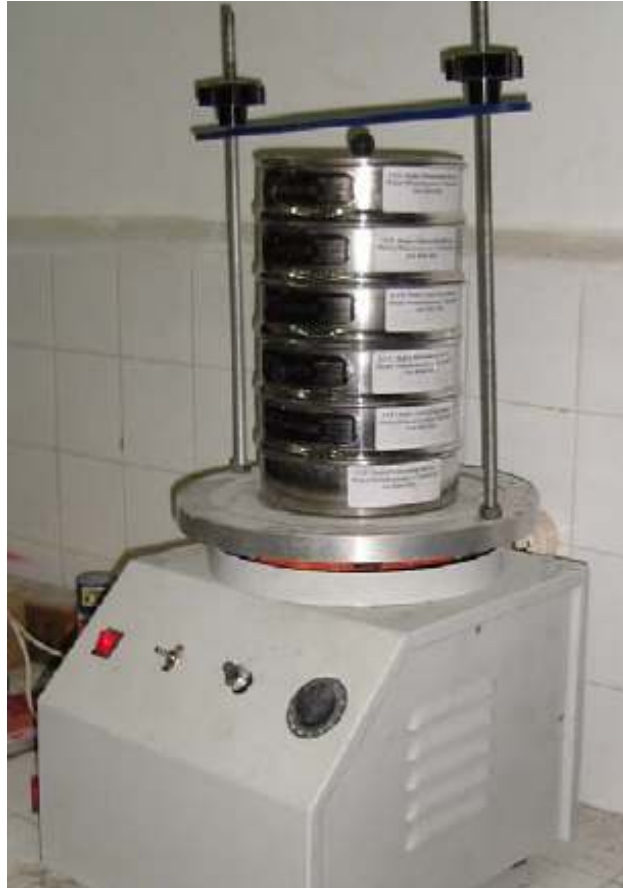
Şekil 3.39: Elek analizlerinde kullanılan titreşimli elek.
