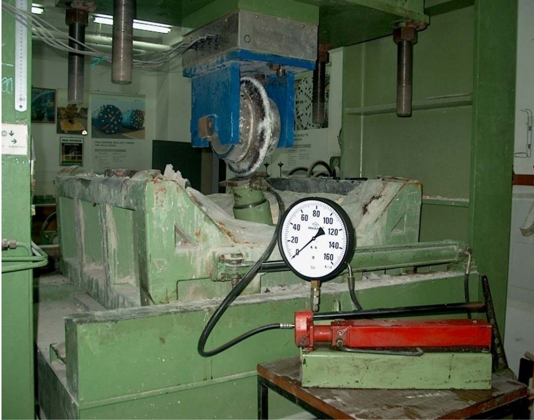
Şekil 3.27: Hidrolik piston ile yapılan kalibrasyon çalışmaları (17 inç CCS tip disk, 15 derece eğim ile yükleme).
