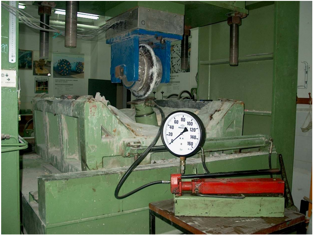
Şekil 3.28: 17 inç CCS tip disk keski için 15 derece eğimde yanal yükleme ile kalibrasyon.
