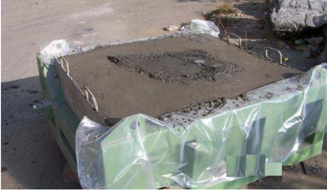
Şekil 3.41: Tam boyutlu doğrusal kazı seti (LCM ) için hazırlanmış örnek numune.
