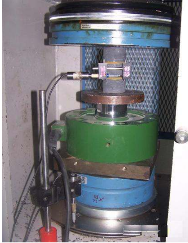
Şekil 3.4: Tek eksenli basınç dayanımı, çekme dayanımı, statik elastisite ve poisson oranı tayini için kullanılan pres.
