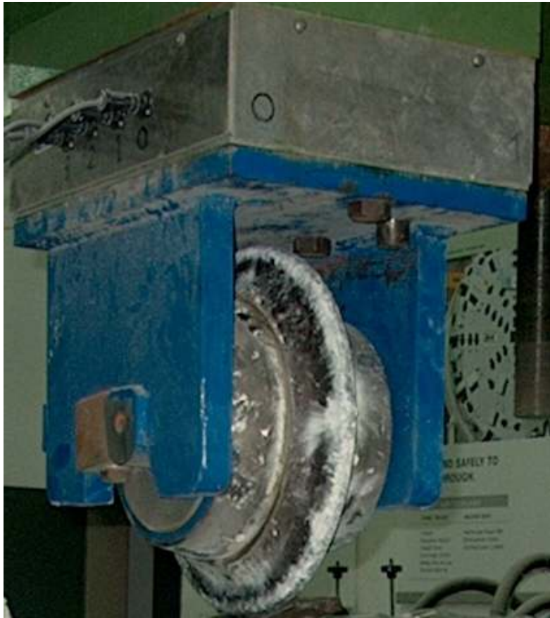
Şekil 3.33: 17 inç CCS tip disk keski.
