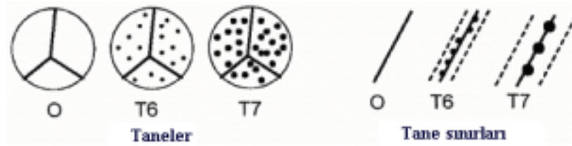
Şekil 3.1: Farklı yaşlandırma şartlarında Al-Zn-Mg-Cu alaşımı için çökelme mekanizmalarının şematik gösterimi. O: Orijinal yapı; T6: Çözeltiye alındıktan sonra yapay yaşlandırılmış yapı; T7: Çözeltiye alındıktan sonra aşırı yaşlandırılmış yapı (Baydoğan, 2003).
