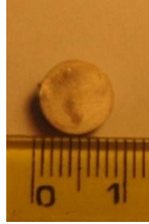
Şekil B.2: Ağırlıkça %1 hidroflorik asit çözeltisinde 10 V'da 10 dk. süreyle anodik oksidasyon uygulanmış 2 mm kalınlığındaki numunenin genel görünümü.
