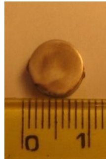
Şekil B.3: Ağırlıkça %1 hidroflorik asit çözeltisinde 20 V'da 15 dk. süreyle anodik oksidasyon uygulanmış 5 mm kalınlığındaki numunenin genel görünümü.
