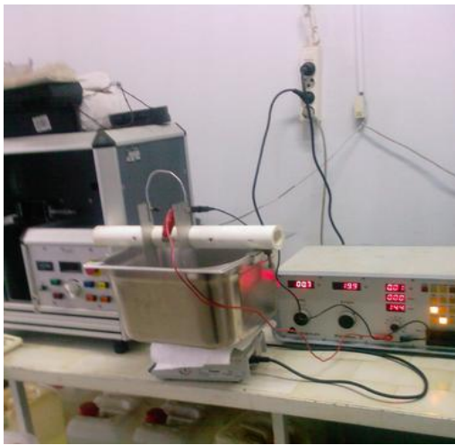
Şekil 4.1: Anodik oksidasyon çalışmalarının yapıldığı düzeneç.
