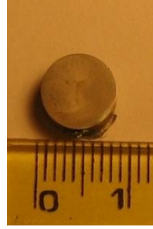
Şekil B.7: Ağırlıkça %1 hidroflorik asit çözeltisinde 20 V'da 30 dk. süreyle anodik oksidasyon uygulanmış 5 mm kalınlığındaki numunenin genel görünümü.
