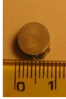
Şekil B.1: Ağırlıkça %1 hidroflorik asit çözeltisinde 10 V'da 10 dk. süreyle anodik oksidasyon uygulanmış 5 mm kalınlığındaki numunenin genel görünümü.
