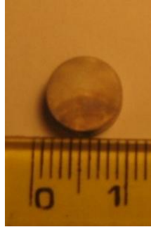
Şekil B.5: Ağırlıkça %1 hidroflorik asit çözeltisinde 10 V'da 20 dk. süreyle anodik oksidasyon uygulanmış 5 mm kalınlığındaki numunenin genel görünümü.
