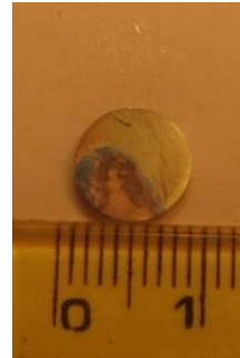
Şekil B.9: Ağırlıkça %1 hidroflorik asit çözeltisinde 30 V'da 60 dk. süreyle anodik oksidasyon uygulanmış 5 mm kalınlığındaki numunenin genel görünümü.
