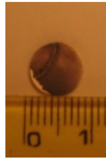
Şekil B.14: Ağırlıkça %1 hidroflorik asit çözeltisinde 10 V'da 80 dk. süreyle anodik oksidasyon uygulanmış 2 mm kalınlığındaki numunenin genel görünümü.
