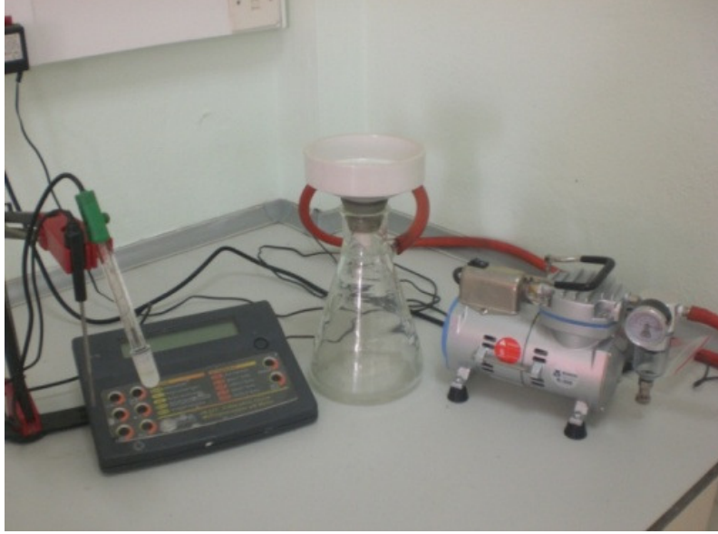
Şekil 3.6: Çözömlendirme sonrası katı-sıvı ayırımının yapıldığı düzeneğin ve çözeltilerin pH değerlerinin ölçüldüğü pH metrenin görünümü.
