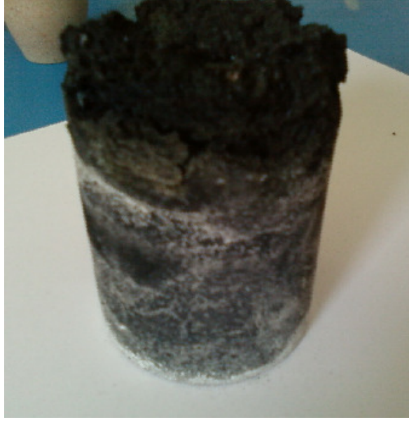
Şekil 4.6 : Pota içerisinde oluşan bütün haldeki SHS ürünü.
