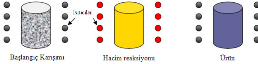
Şekil 2.18 : Eşzamanlı yanma biçiminin şematik gösterimi [32].
