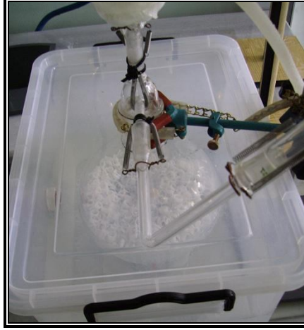
Şekil 4.23 : Spirale bağlı cam boncuk ve teflon rashing dolgulu gaz yıkama şişesi Belirtilen değişiklikler doğrultusunda Şekil 4.13’de bulunan birinci deney düzeneği akış diyagramı, Şekil 4.24’de gösterilen ikinci deney düzeneği akış diyagramı şeklinde geliştirilmiştir.
