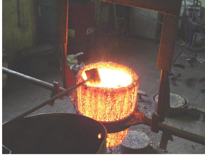
Şekil 5.3 : Döküm işlemi öncesinde, cüruf ve diğer kalıntıların potadan temizlenmesi işlemi
