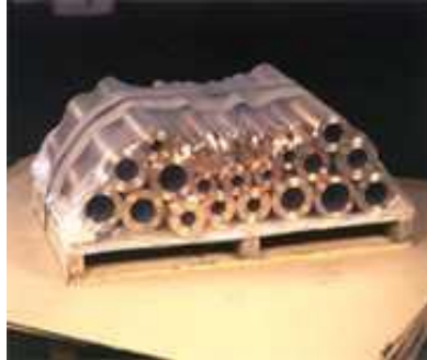
Şekil 5.1 : Sarkuysan’da, DIN 1716, 1714, 1709 ; ASTM B30, BS 1400 normlarında, çeşitli ebatlarda üretilen bronzlar
