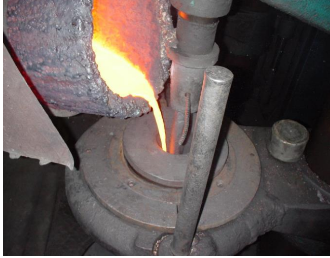
Şekil 5.4 : Düşey savurma döküm cihazında yapılan dökümün görünümü
