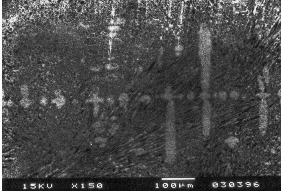
Şekil 6.29. Kokil kalıba dökülerek elde edilen ve 950 °C ’de 2 saat destabilizasyon ısı işlemi uygulanan numunenin SEM mikroyapı fotoğrafı.
