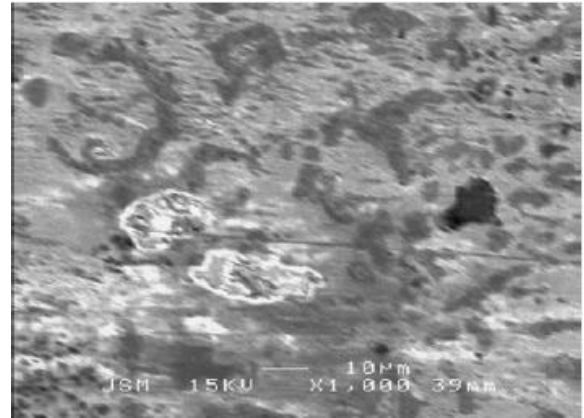
Şekil H.3.2. Isıl işlemlili halka ile çalışan mangan fosfat kaplı 3 no.lu.blok numunesi (aşınma izi – 1000x)
