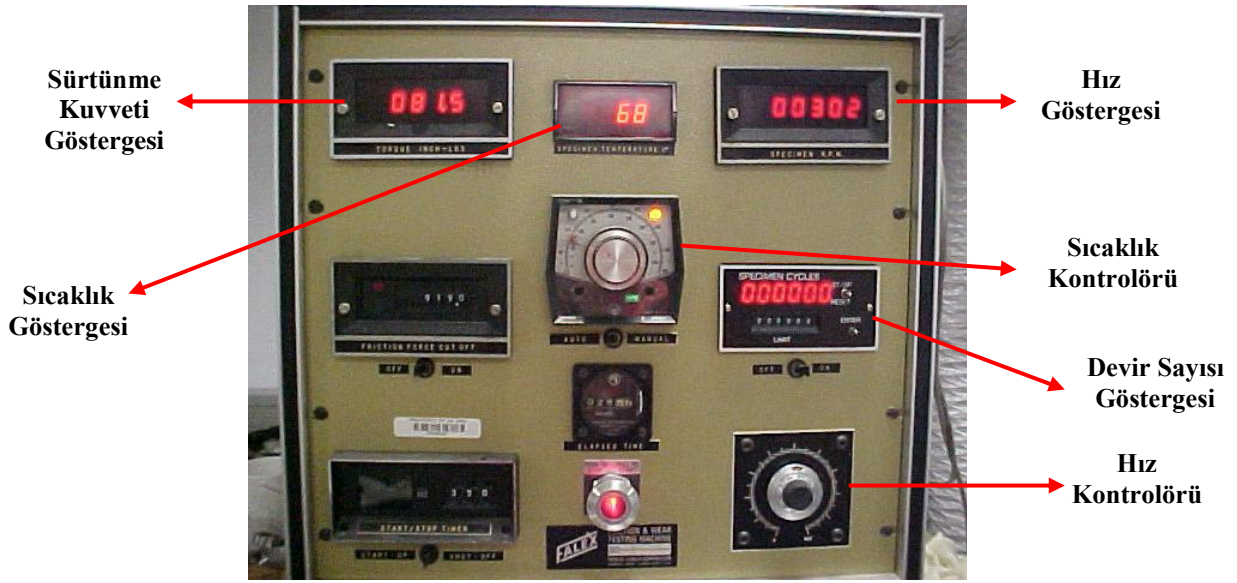
Şekil 5.3 Block on Ring cihazı kontrol ünitesi [35].
