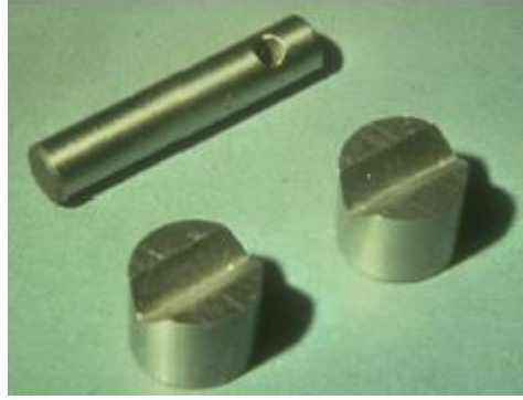
Şekil 4.3 Pin & V Block test cihazı standart pim ve V bloğu numuneleri [31].
