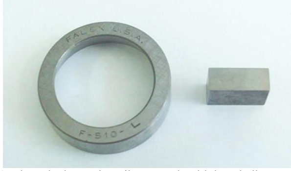
Şekil 4.6 Falex Block on Ring cihazı standart blok ve halka numuneleri
