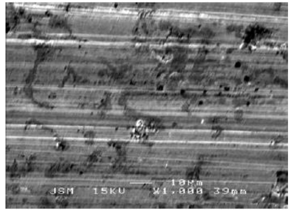
Şekil I.3.2. Nitrürlü halka ile çalışan mangan fosfat kaplı 3 no.lu.blok numunesi (aşınma izi – 1000x)
