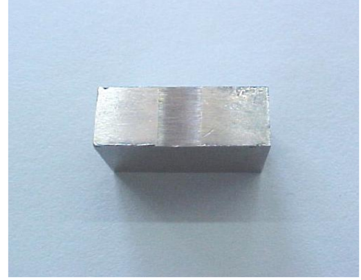
Şekil 5.10 Blok numunesi aşınma izi görüntüsü [34].
