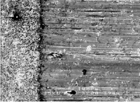
Şekil I.1.1. Nitrürlü halka ile çalışan mangan fosfat kaplı 1 no.lu.blok numunesi (aşınma bölgesi – 200x)
