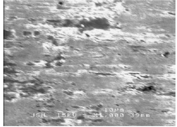
Şekil H.2.2. Isıl işlemlili halka ile çalışan mangan fosfat kaplı 2 no.lu.blok numunesi (aşınma izi – 1000x)
