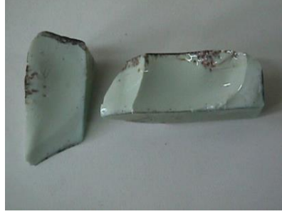
Şekil 5.7: %92curuf-%8ZnO bileşiminin 1445°C' de dökümüyle elde edilen renk.
