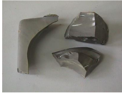
Şekil 5.8: %92(curuf+%10TiO 2 )-%8ZnO bileşiminin 1445°C' de dökümüyle elde edilen renk.
