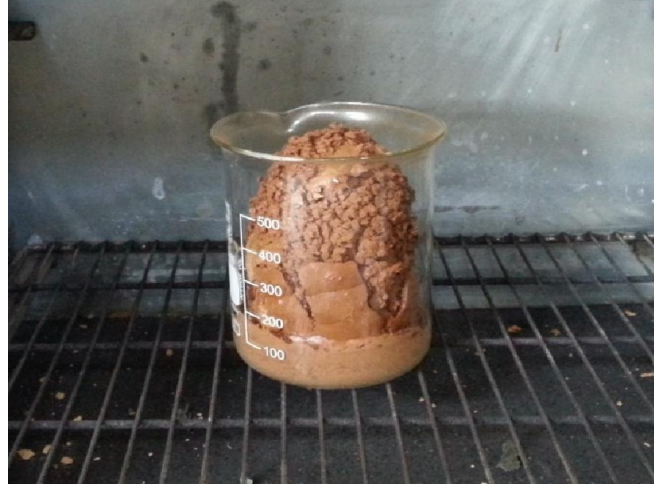
Şekil 4.3 : Etüv sonrası numunelerin görünümü.
