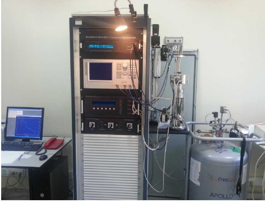
Şekil 4.10 : BDS-40 model Broadband Dielectric/Impedance Spectrometer cihazı.
