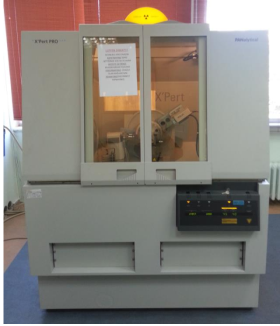
Şekil 6.3 : Kullanılan PANalytical marka XRD cihazı.
