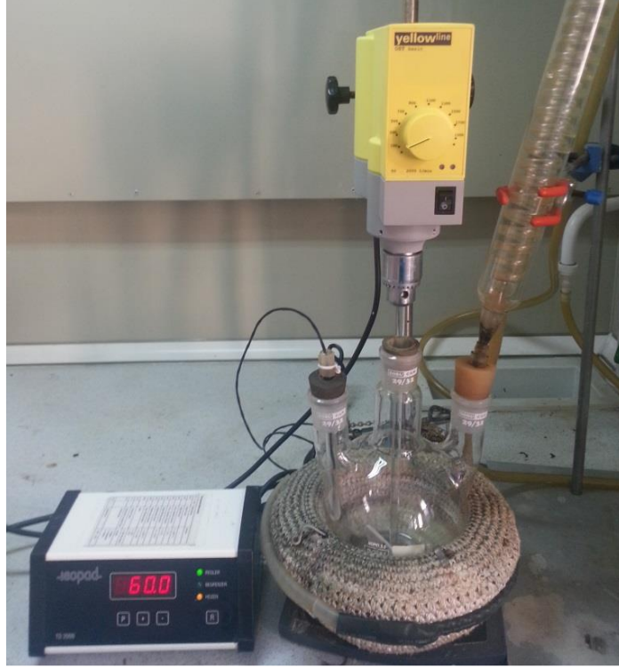
Şekil 6.9 : Deneylerin yapıldığı liç deney düzeneği.
