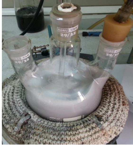
Şekil 6.10 : Toz ilavesi ile köpürmelerin oluşumu.
