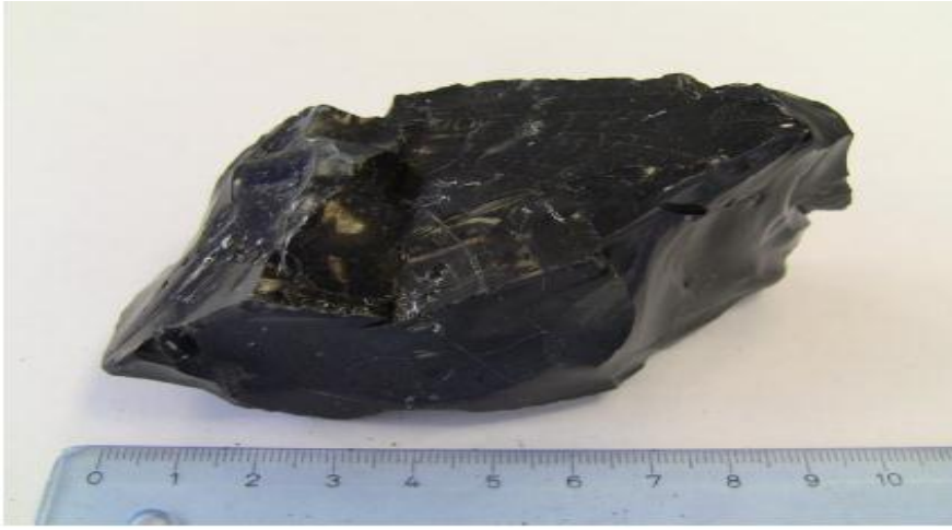
Şekil 2.1 : Tipik bir soda-boraks esaslı curufun görüntüsü.
