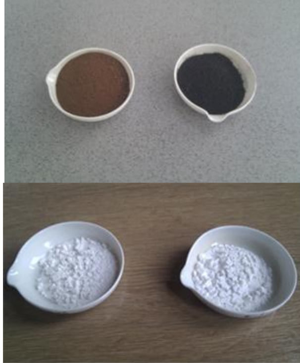
Şekil 4.8 : Kalsinasyon öncesi (üst resim) ve sonrası (alt resim) numuneler.
