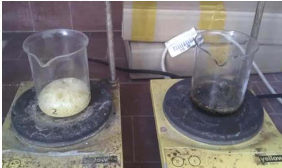
Şekil 4.6 : Ani yanma reaksiyonu sonrası numuneler.
