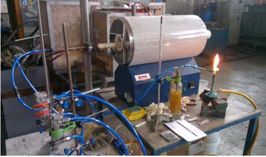
Şekil 4.13 : Oksidan ve redüktan deney düzeneği
