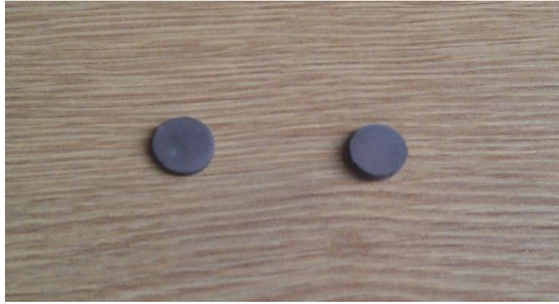
Şekil 4.10 : 1300°C’de ısıtılma işlemi görmüş peletler.
