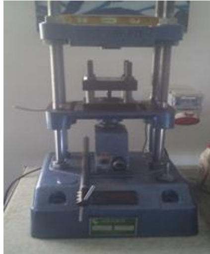
Şekil 4.3 : Pelet üretiminde kullanılan 10 tonluk pres.
