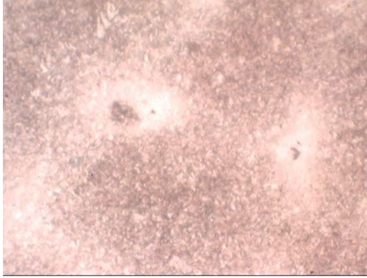
Şekil 5.13. 10x kod no'lu numunenin x500 büyütmedeki mikroyapısı
