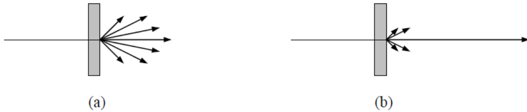
Şekil 2.3: Işık geçirgenliğinin açıklanması a) yarı saydam malzeme, b) saydam malzeme [53].
