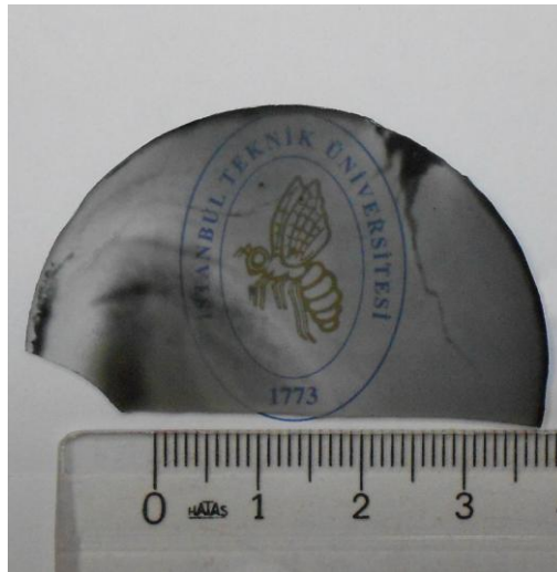
Şekil 4.23 : % 0,5 MgO içeren toz karışımının 1600 °C' de 30 dakika süre ile spark plazma sinterlenmesi ile elde edilen numune.
