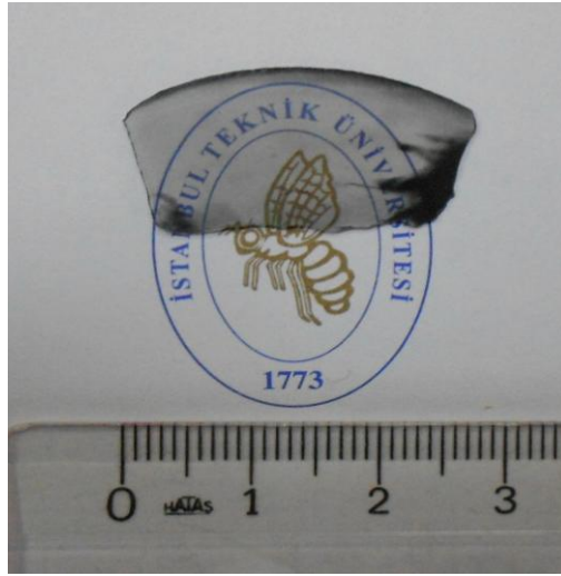
Şekil 4.22 : % 0,5 MgO içeren toz karışımının 1650 °C' de 30 dakika süre ile spark plazma sinterlenmesi ile elde edilen numune.
