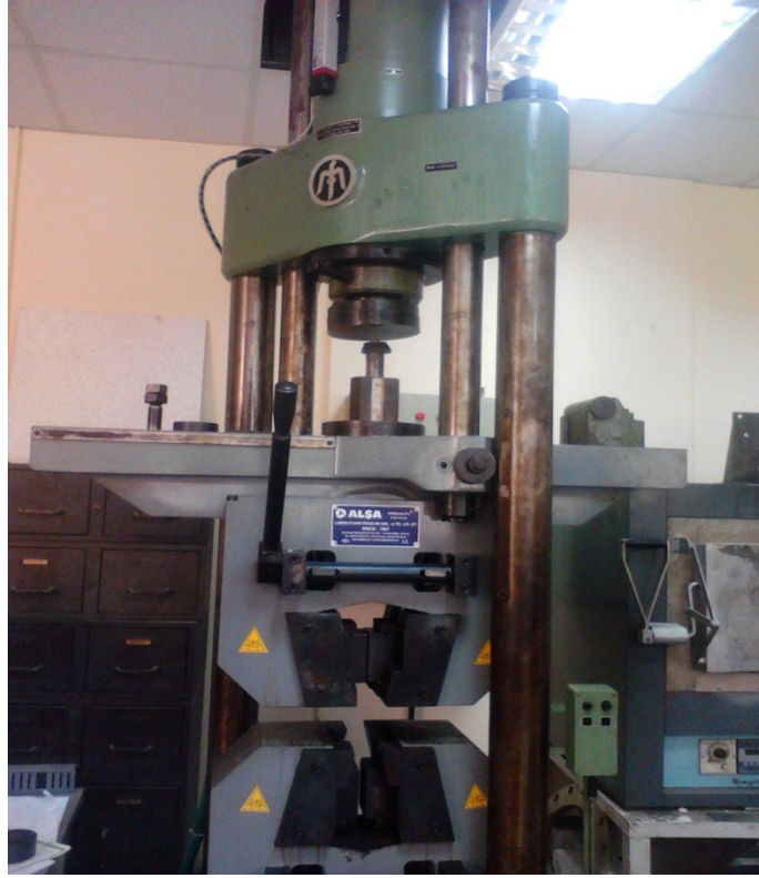
Şekil 5.2 : Basma ve çekme cihazı.
