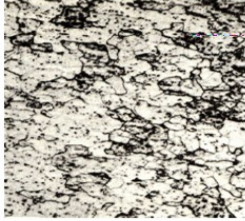
Şekil 1.1 : % 12 krom içeren ferritik bir mikroyapı (Url-1).
