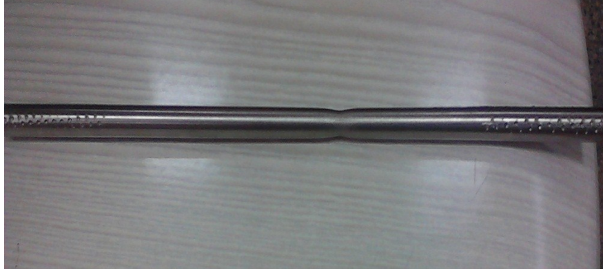
Şekil 6.18 : Çekme işlemi sonrası paslanmaz çelik çubuktaki değişim.
