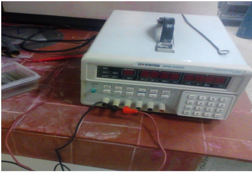
Şekil 5.4 : Elektrolitik dağlama düzeneği.
