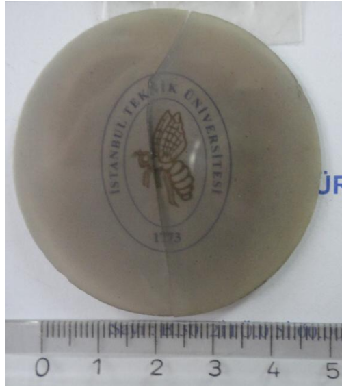
Şekil 4.30 : 8 °C/dk’lık ısıtma hızı ile ısıtılarak 1175 °C’de 20 dakika süre ile sinterlenen 150 ppm MgO ve 150 ppm Y 2 O 3 içeren numune
