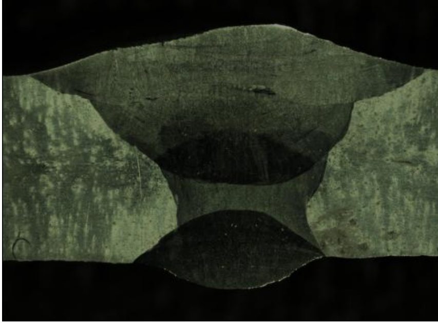
Şekil 6.5: LTT 2 numunesine ait kaynak bölgesi makro görüntüsü
