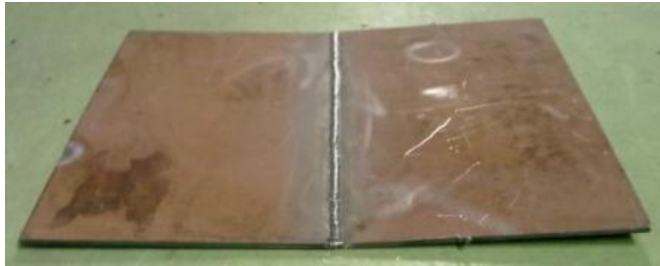
Şekil 5.5 Kaynak işlemi gerçekleştirilmiş kaynaklı plaka örneği
