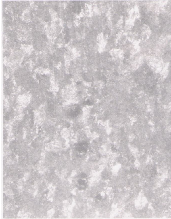
Şekil 9.6 : 8006 alaşımının tablet ile degaze edilmesinden sonra elde edilen metalografik imaj (X100)
