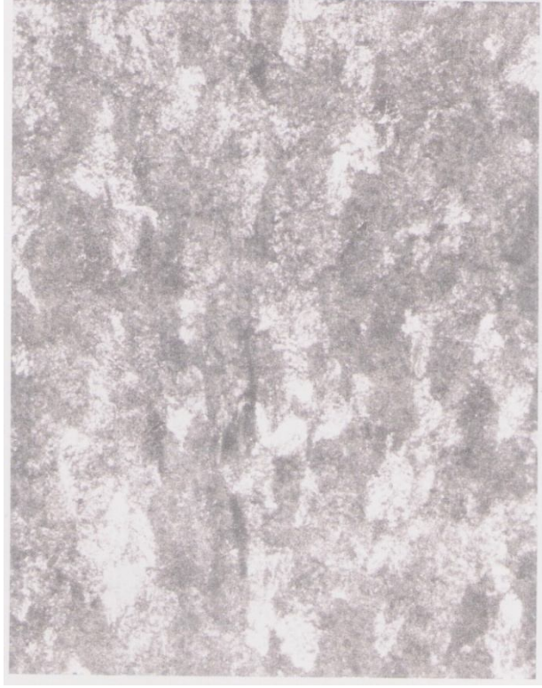
Şekil 9.7 : 8006 alaşımlının %90azot+%10klor karışımı ile degaze edilmesinden sonra elde edilen metalografik imaj (X100)
