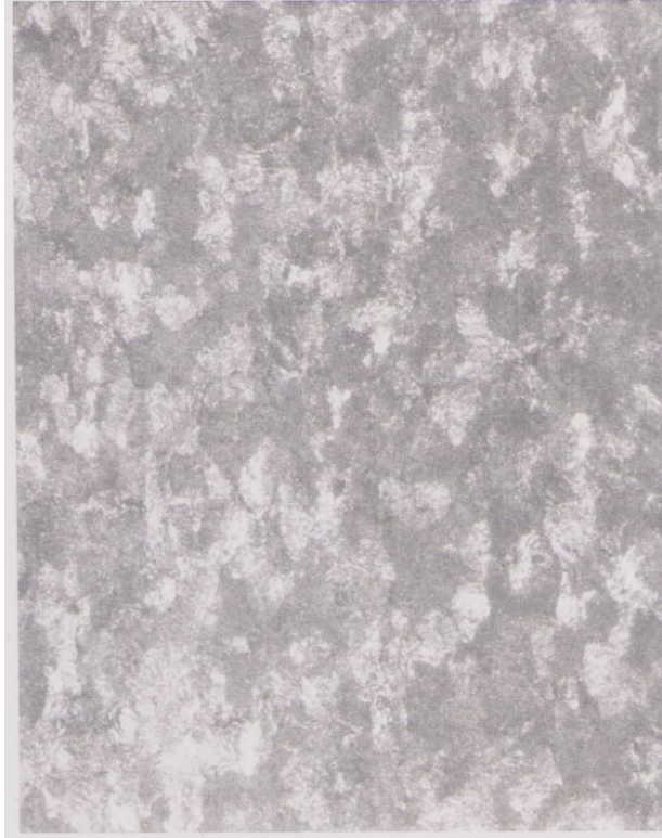
Şekil 9.8 : 8006 alaşımlının enjeksiyon cihazı ile degaze edilmesinden sonra elde edilen metalografik imaj (X100)
