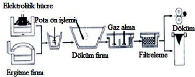
Şekil 8.3 : Alüminyum ergitme ve rafine etme akış şeması (Peterson, 1995).
