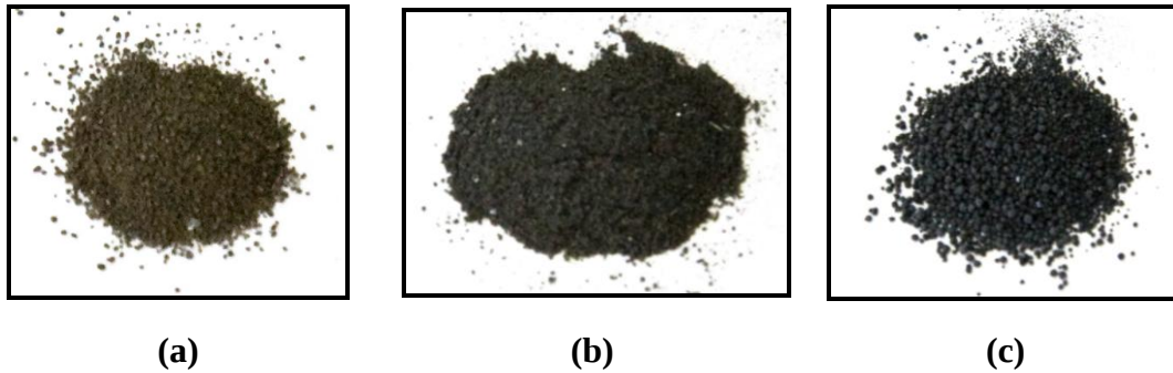
Şekil 5.13 : Üretilen bor tozlarının fotoğrafları (a) 900°C, (b) 1000°C, (c) 1100°C
