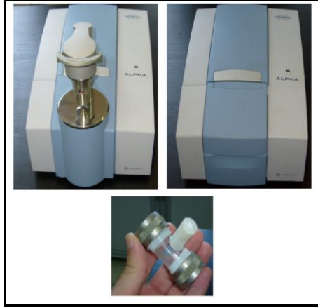
Şekil 4.13 : FTIR cihazı ve gaz hücresi
