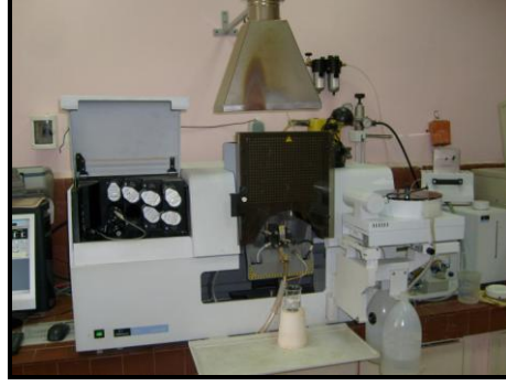
Şekil 4.16 : Atomik absorpsiyon spektrofotometresi
