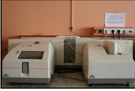
Şekil 4.15 : Partikül boyutu ölçüm cihazı
