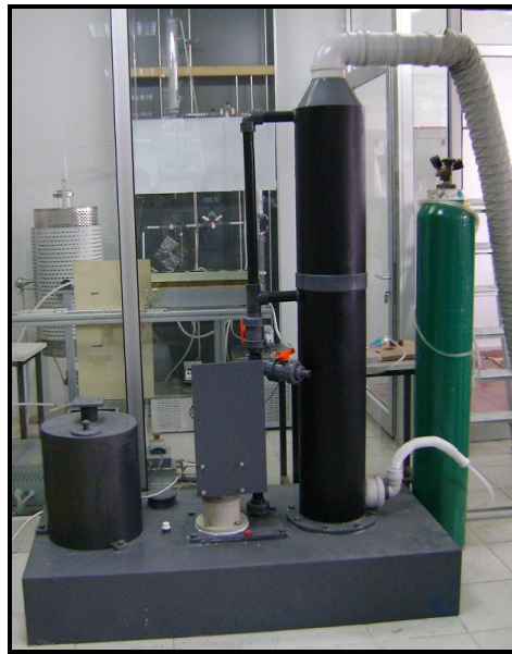
Şekil 4.8 : Gaz yıkama kulesi
